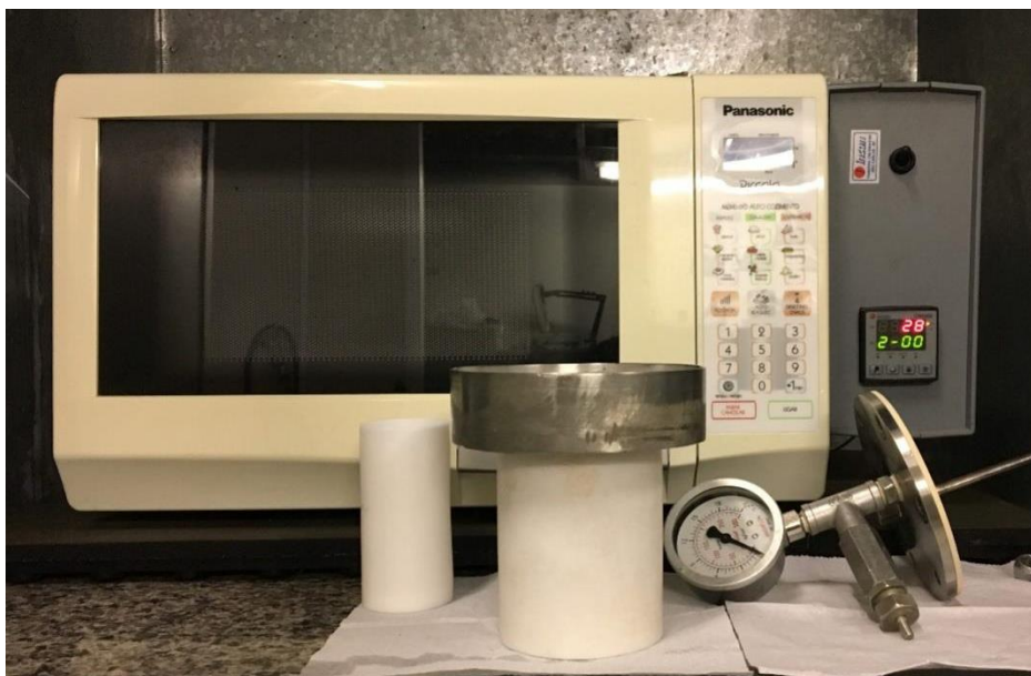
Figura 5: Foto da autoclave instalada no forno micro-ondas 2,45 GHz, potencial fixo de 1,0 kW e controle de temperatura.
