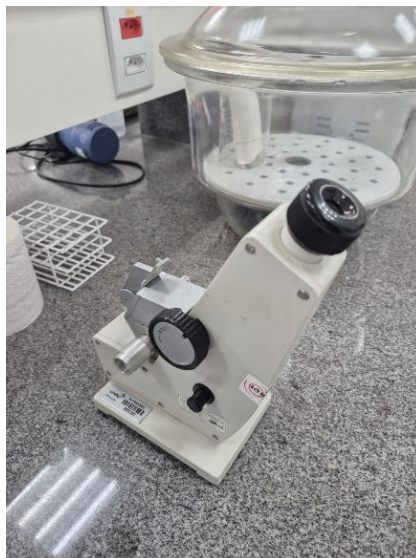
Figura 7 - Refratômetro ABBE utilizado para medir o índice de refração.
