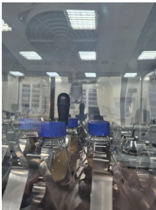
Figura 8 - Amostra dentro do reator de batelada utilizado na reação de transesterificação.
