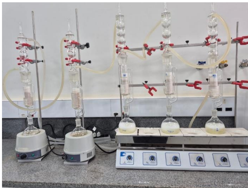
Figura 4 - Método de Soxhlet utilizado para extração do óleo da semente de melão
