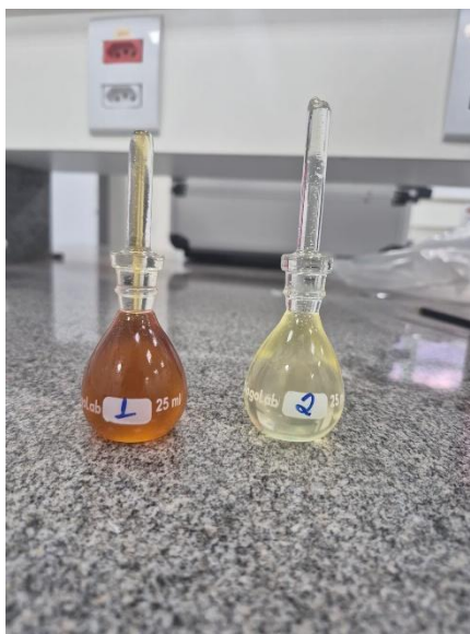
Figura 5 - Picnômetro utilizado para determinação da densidade do óleo.
