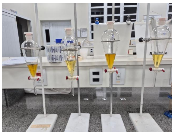
Figura 9 - Decantação da mistura resultante do processo de transesterificação.
