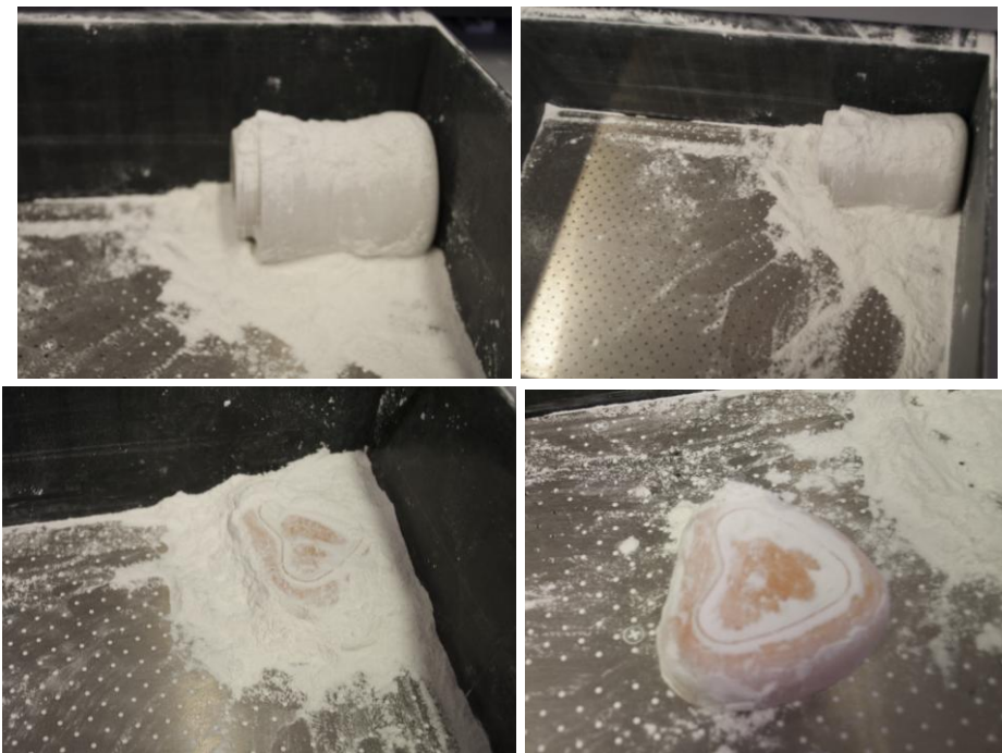
Figura 88 – Objeto sendo produzido na impressora Z Printer.
