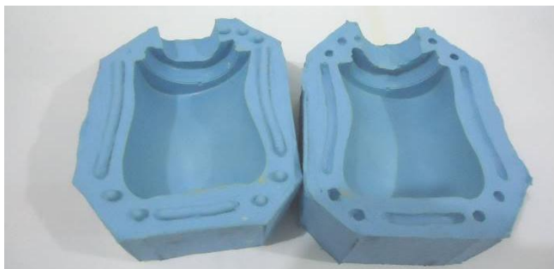
Figura 29 – Molde de Silicone
