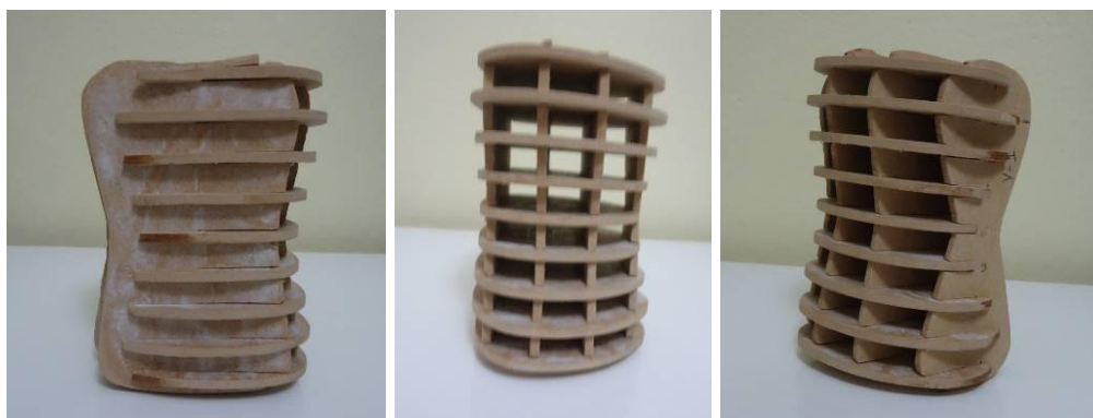
Figura 69 – Modelo de chapa de MDF com encaixe finalizado.
