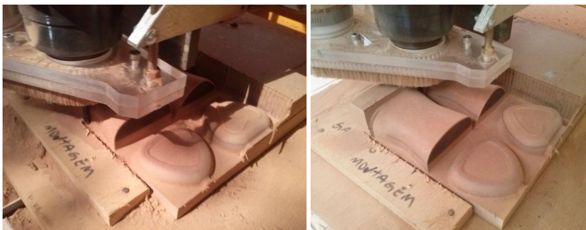
Figura 96 – Fase de acabamento.
