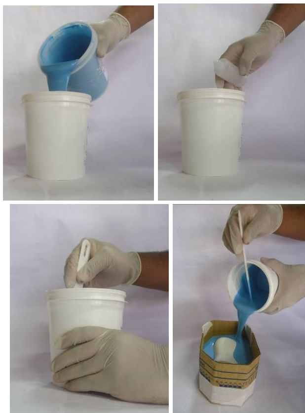
Figura 26 – Mistura silicone /catalisador e construção da primeira parte do molde.
