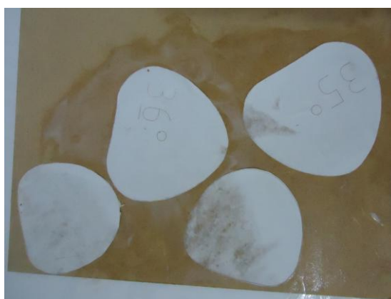
Figura 72 – Desenho gerado pelo software colado na chapa de MDF.
