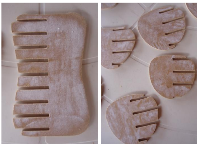
Figura 67 – Fatias lixadas e com acabamento.
