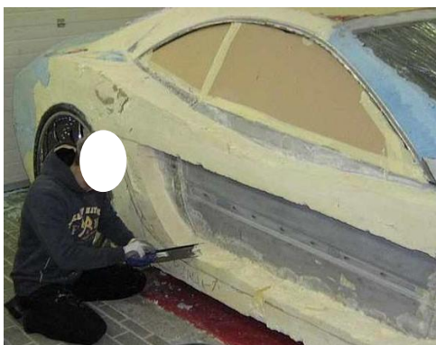
Figura 13 – Usinagem manual de Poliuretano Rígido.
