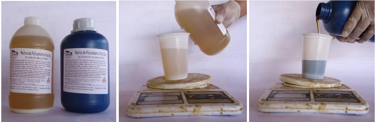
Figura 34 – pesagem e separação dos componentes da resina de Poliuretano.
