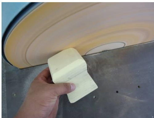
Figura 79 – Modelo de Poliuretano recebendo acabamento.
