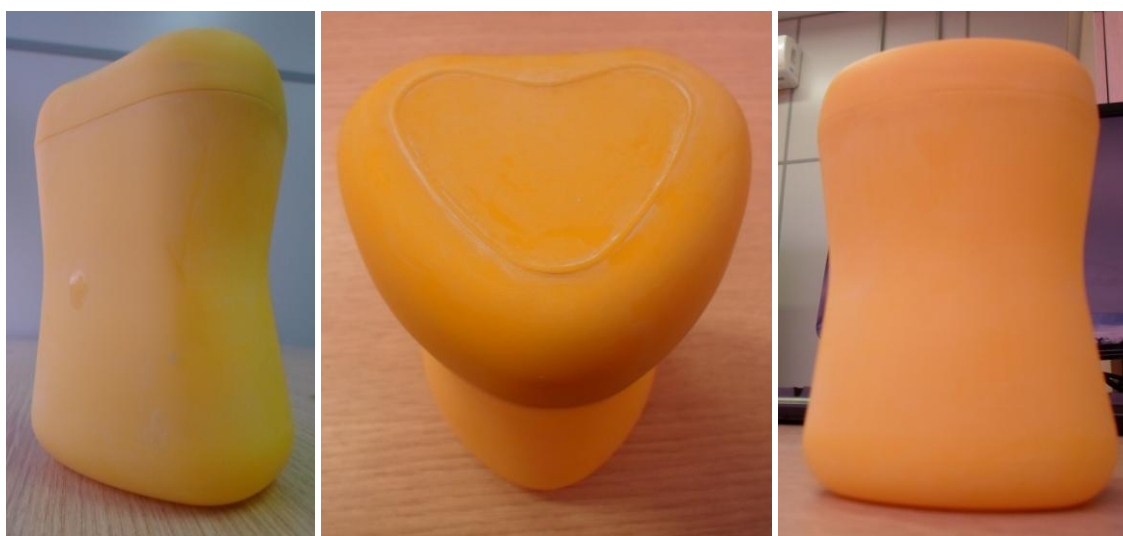
Figura 86 – Objeto impresso na Z Builder finalizado.
