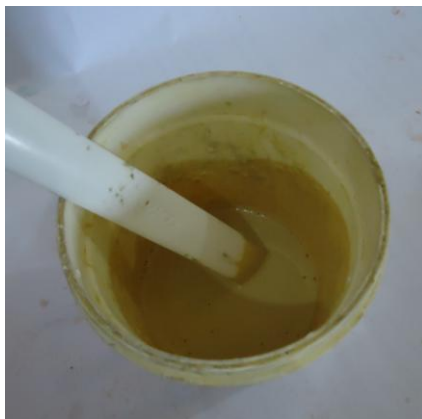
Figura 42 – Mistura do gesso com a água e consistência final.
