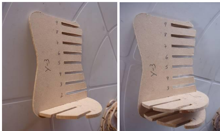
Figura 68 – Colagem das fatias na ordem especificada pelo software.
