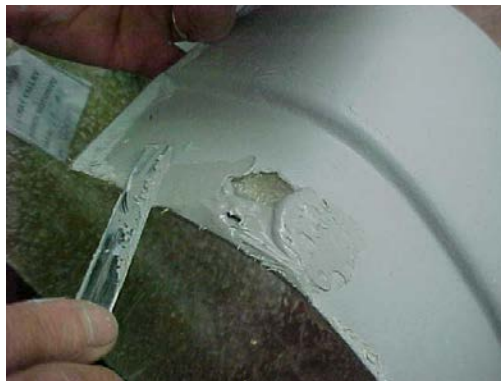
Figura 21 – Reparo e acabamento feito com massa plástica.
