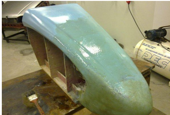
Figura 20 – Laminação com resina de poliéster e fibra de vidro.
