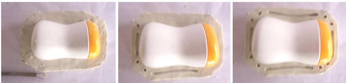
Figura 24 – Marcas que servirão de guia para o encaixe do molde.
