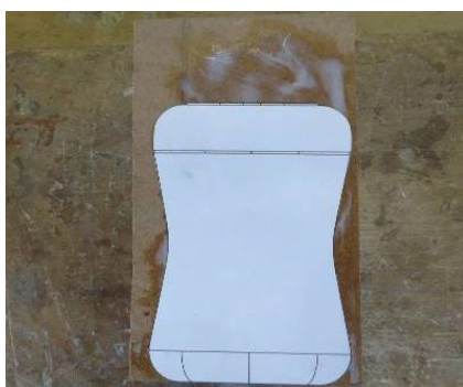
Figura 60 – Vistas do objeto coladas no bloco de MDF.
