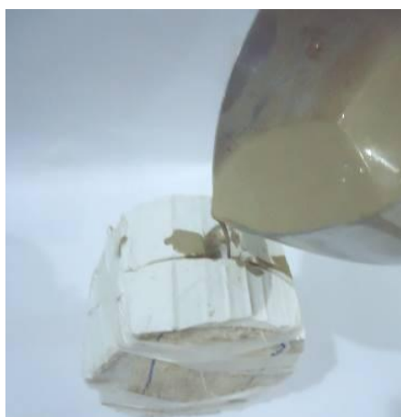
Figura 48 – Preenchimento do molde com cera.
