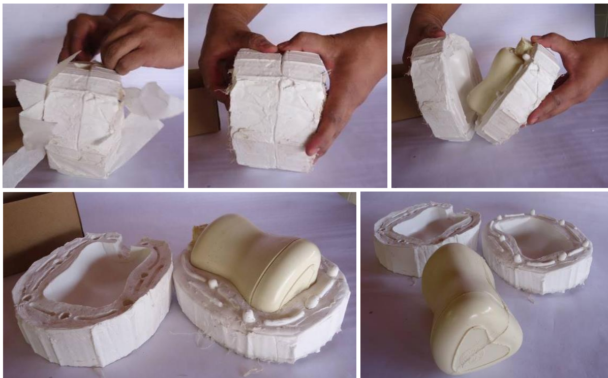
Figura 37 – Abertura do molde e modelo em resina de Poliuretano.
