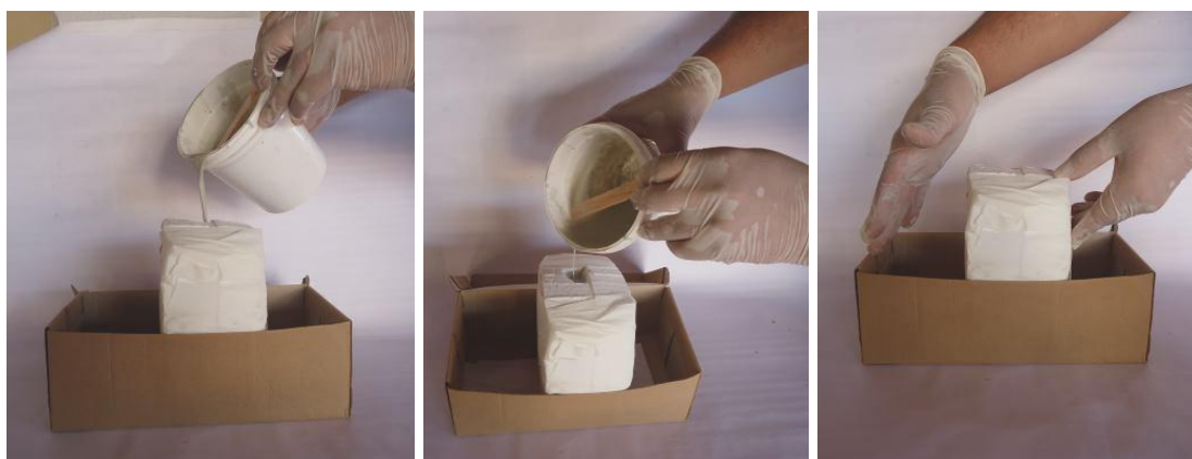
Figura 32 – Preenchimento do molde.
