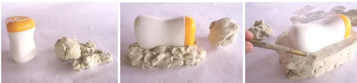
Figura 23 – Cama feita em plastilina para acomodar a peça que será moldada.
