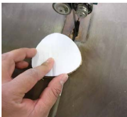
Figura 73 – Fatia sendo cortada com auxílio da serra de fita.
