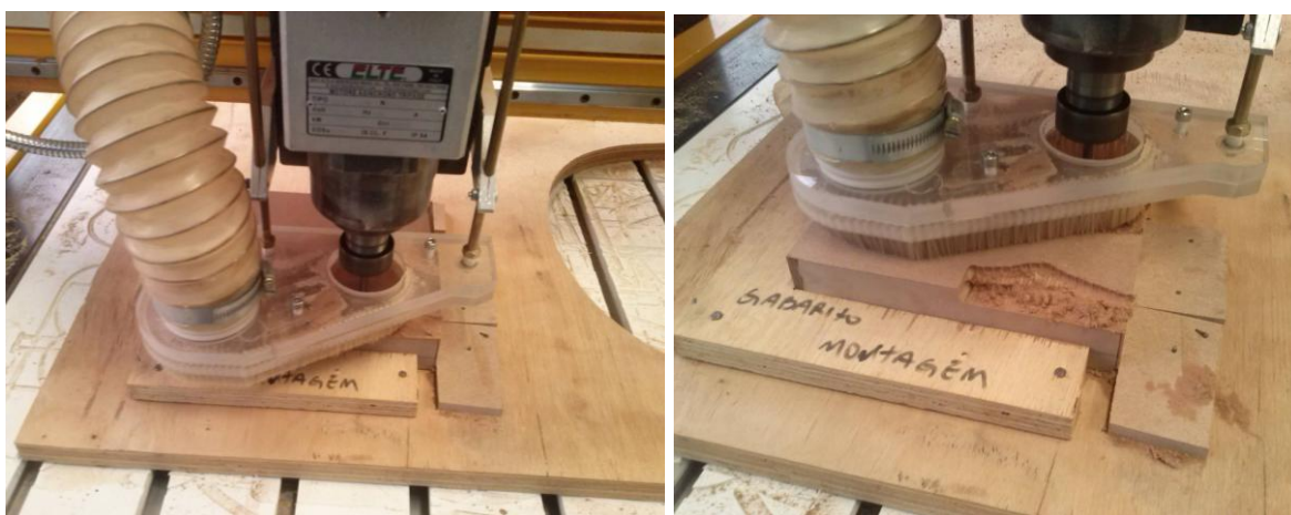
Figura 95 – Processo de usinagem da Fresadora Router.
