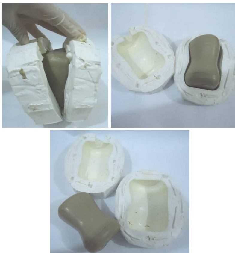
Figura 49 – Abertura do molde e modelo em cera.
