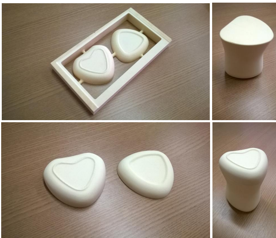
Figura 93 – Modelo finalizado na Roland CNC.
