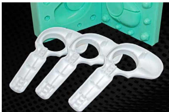
Figura 18 – Peças em resina de poliuretano.
