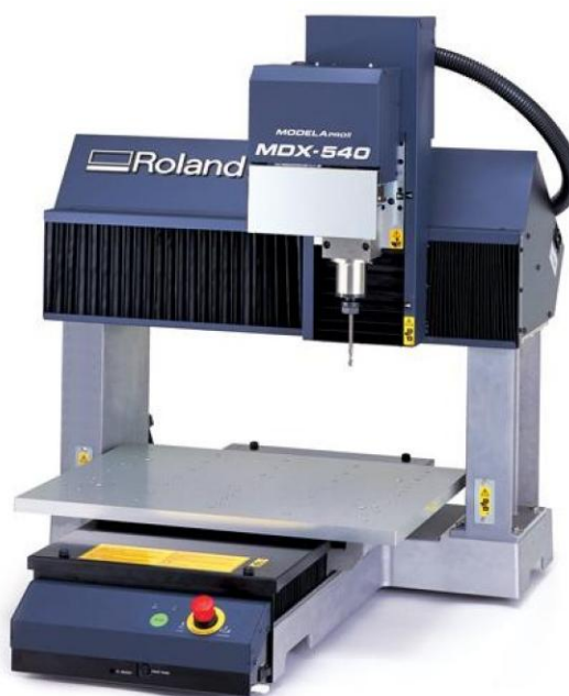
Figura 102 – Fresadora CNC Roland MDX 540.
