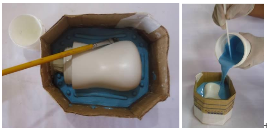
Figura 28 – Construção da segunda parte do molde.
