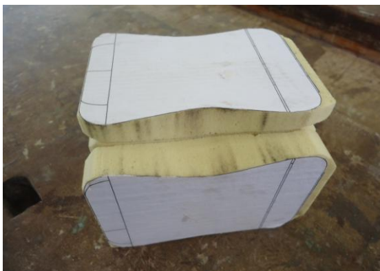
Figura 77 – Desenhos das vistas colados no bloco de Poliuretano.
