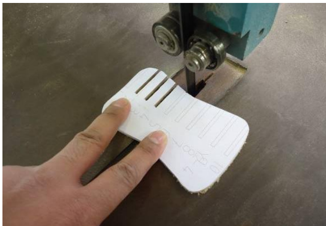
Figura 66 – Fatia com encaixes sendo cortada na serra de fita.
