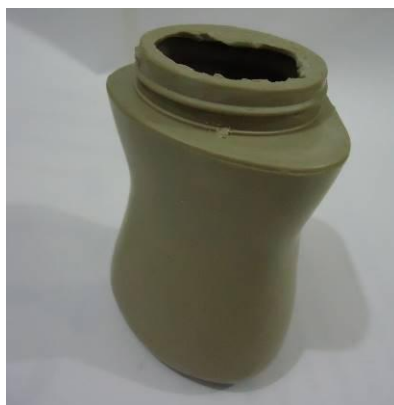
Figura 50 – Modelo em cera por processo de rotomoldagem.
