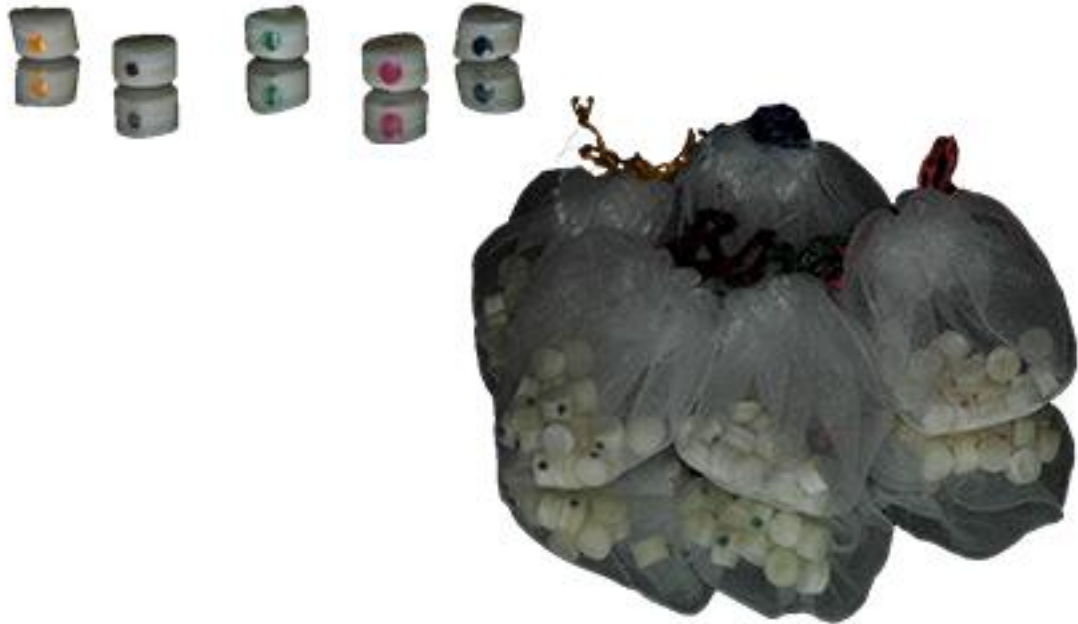
Figura 12 - Espécimes e suas devidas marcações: verde – espécime íntegro (GI), laranja – somente preparo cavitário (GII), roxo – resina composta (GIII) , azul –cimento de ionômero de vidro modificado por resina (GIV) e rosa – adesivo autocondicionante (GV)
