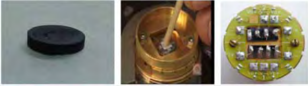
Figura 4.3: Figura de uma amostra pastilhada, de uma amostra sendo inserida no porta amostra para medida de calor específico e de amostras no porta amostras para medidas de resistividade. Retirado da referência [65].
