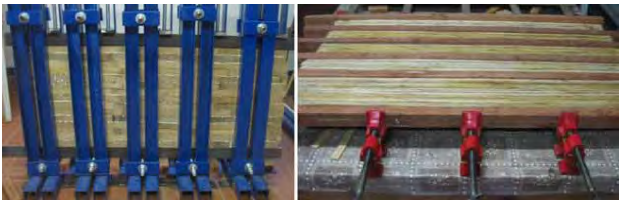
Figura 24. Colagem lado a lado em prensa mecânica e colagem face a face em sargentos de trilho (fotos Marco Pereira).
