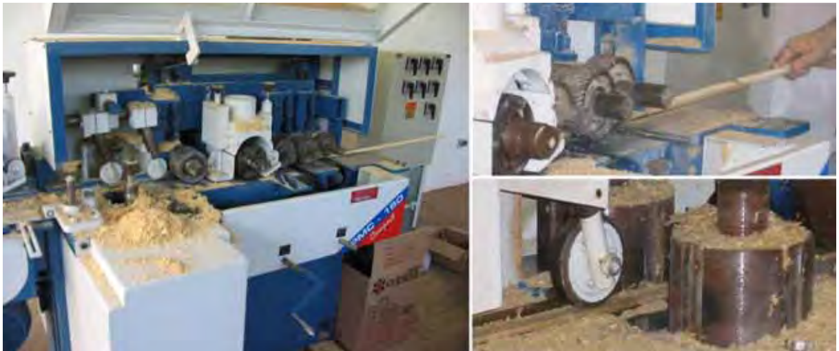
Figura 21. Plana de 4 faces em processo de laminação das ripas de bambu (fotos Marco Pereira).
