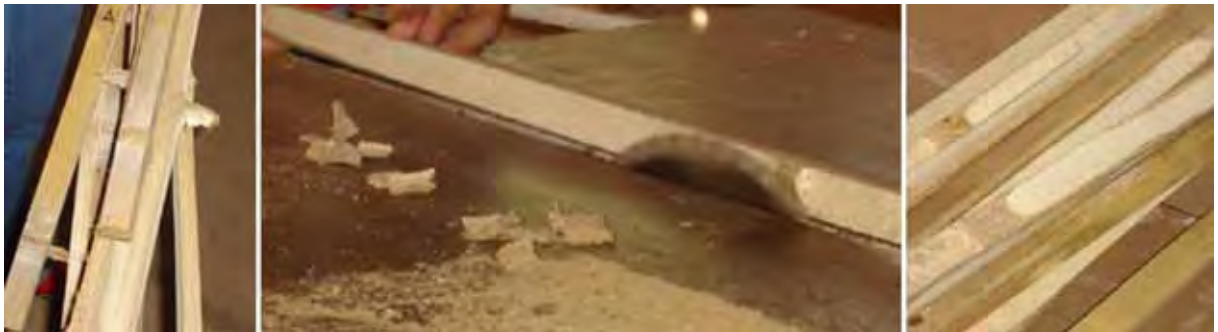
Figura 20. Ripas refiladas, remoção do excesso de material nos nós e ripas prontas para o processo de laminação (fotos Marco Pereira).
