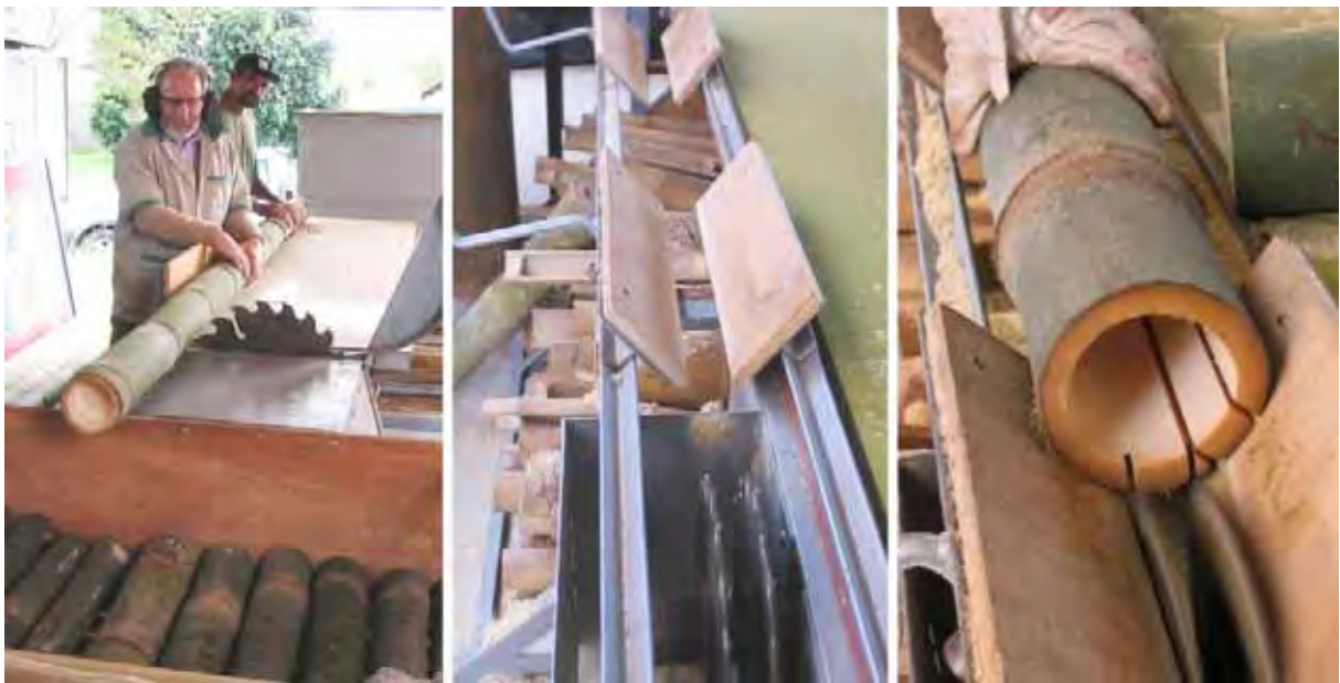
Figura 18. Processamento do colmo em serra circular destopadeira – à esquerda, máquina serra circular dupla refiladeira – ao centro – e colmo sendo refilado em ripas (fotos Marco Pereira).
