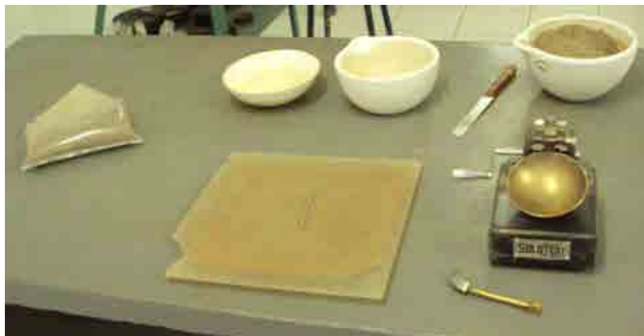
Figura 4.5 - Equipamentos para determinação dos limites de Atterberg (AUTOR, 2011)
