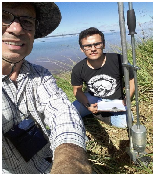
Figura 24 - Penetrômetro cravado e realização das leituras de profundidade.
