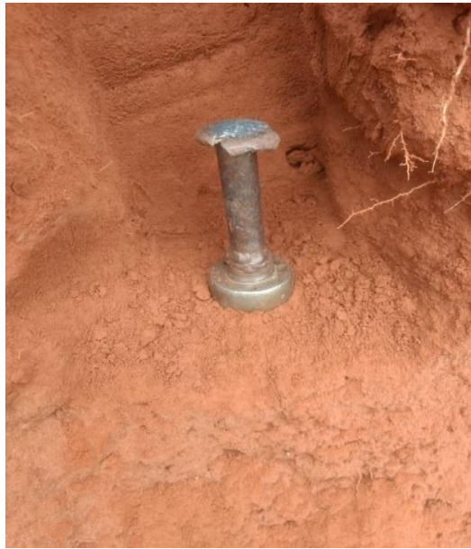
Figura 16 - Anel volumétrico cravado no solo.
