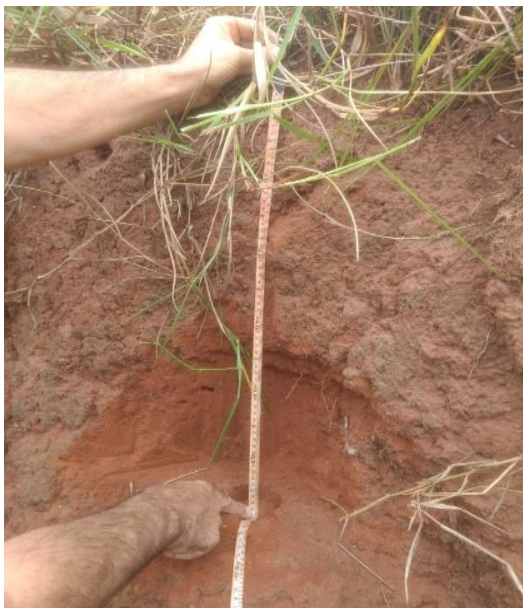
Figura 14 - Medição da profundidade de coleta.
