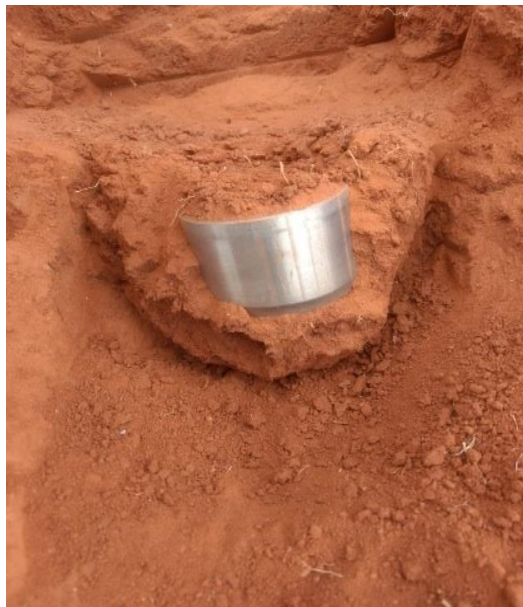
Figura 17 - Anel volumétrico sendo retirado.
