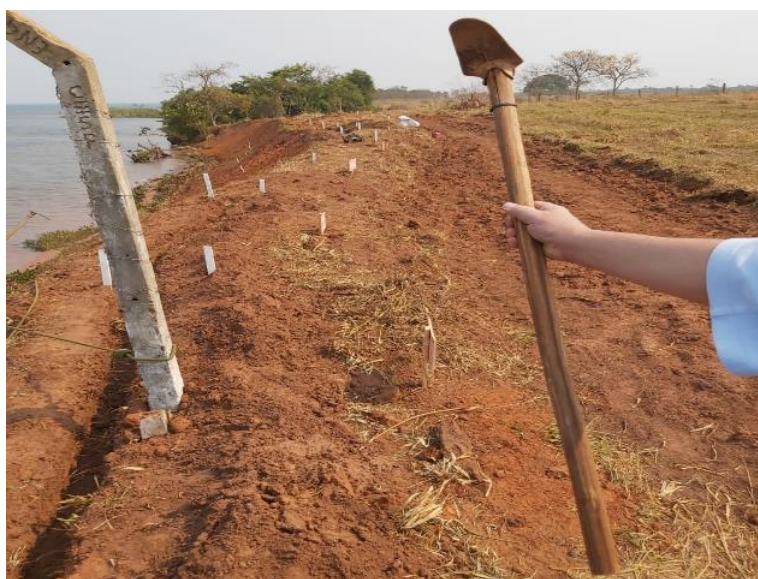
Figura 46 - Enxada para coveamento.
