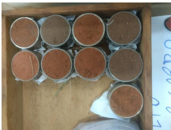
Figura 20 - Amostras indeformadas prontas para envio ao laboratório.
