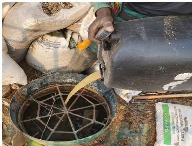
Figura 54 - Despejo do fixador AG 60 no tanque.
