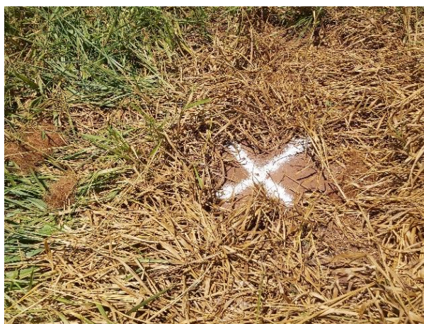
Figura 84 - Pontos de controle para ortorretificação das imagens.
