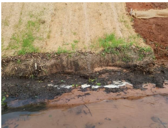
Figura 142 - Parcela 8, destacando o solapamento ocorrido nessa parcela (foto de 09/10/2019).
