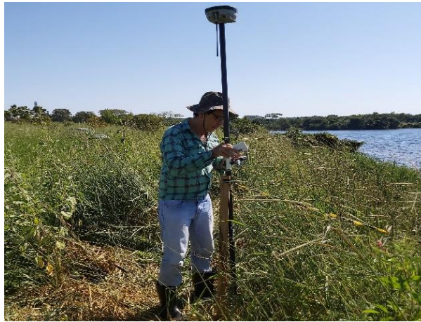
Figura 85 - Georreferenciamento de ponto de controle para ortorretificação das imagens.
