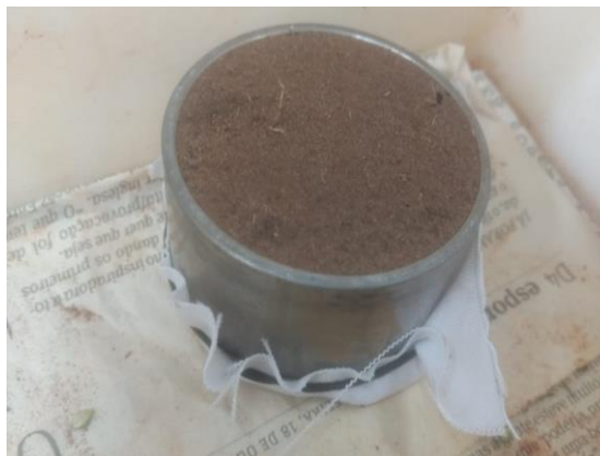
Figura 19 - Amostra indeformada pronta.
