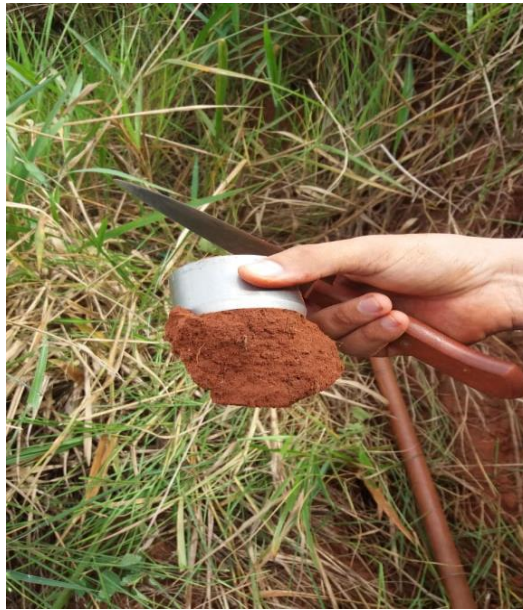
Figura 18 - Anel volumétrico retirado com excesso de solo.
