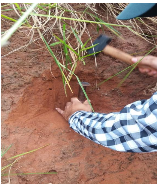
Figura 15 - Anel volumétrico sendo introduzido no solo com auxílio do percussor.
