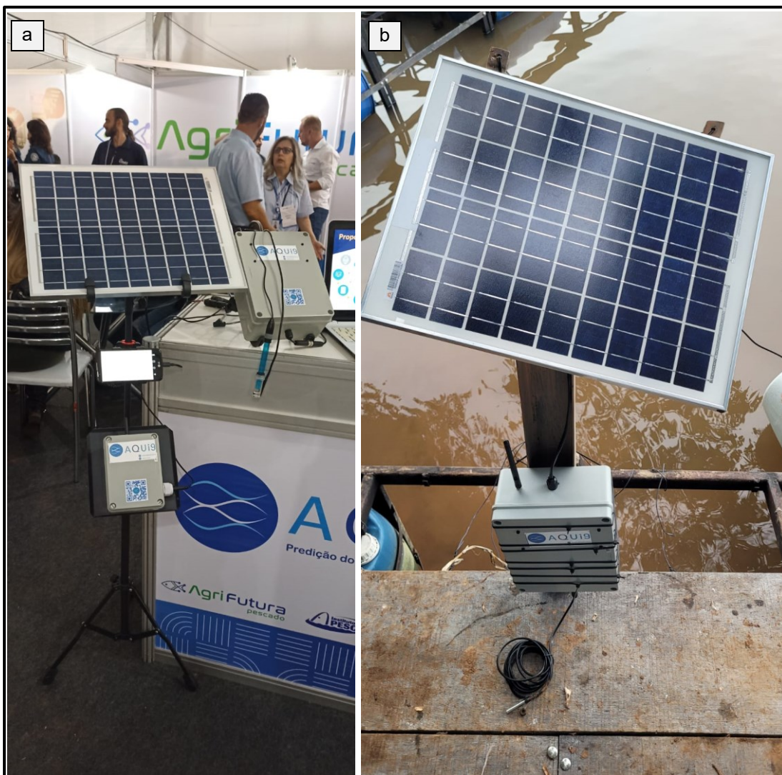
Figura 26. Equipamentos com sistema de energia renovável (fotovoltaico), módulo de sensores com bateria, transmissão de dados via LoRaWAN® e conexão com wifi. (a) equipamento em exposição (eventos) e (b) equipamento instalado na fazenda parceira Cristalina LTDA.
