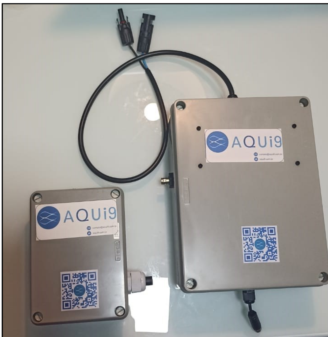
Figura 25. Equipamentos (módulos) plugin-play de captação de dados no campo e transmissão de dados ( gateway ) em tempo real para o sistema Aquability®.
