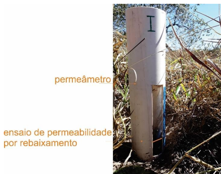
Figura 4: Ensaio de permeabilidade
