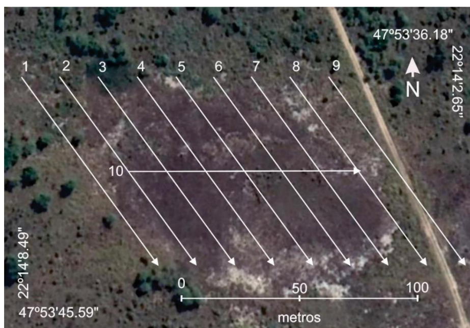
Figura 8: Linhas de aquisição geofísica na área úmida. As setas indicam sentido da tomografia elétrica.
