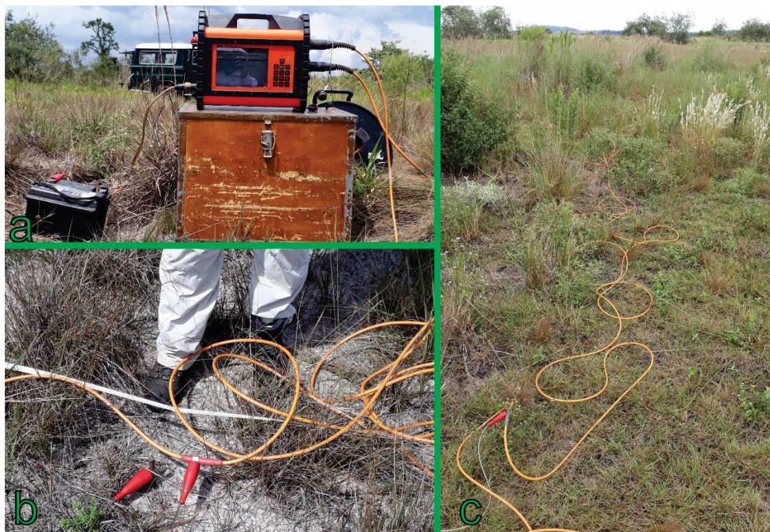
Figura 9: Aquisição de dados geoeletricos, a) equipamento conectado na bateria; b) cabo elétrico conectado por garra ao eletrodo metálico; c) linha geofísica.
