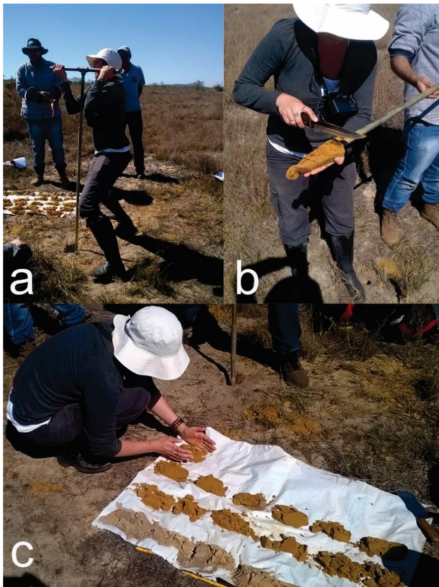
Figura 11: Processo de tradagem, a) efetuando a tradagem; b) descartando possíveis contaminações; c) organizando as profundidades tradadas para descrição.
