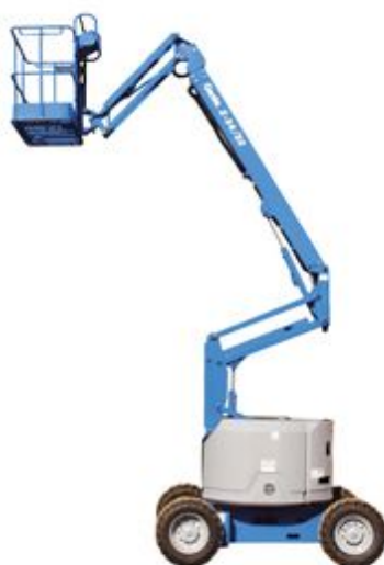
Figura 16 – Imagem da plataforma elevatória semelhante à utilizada em obra
