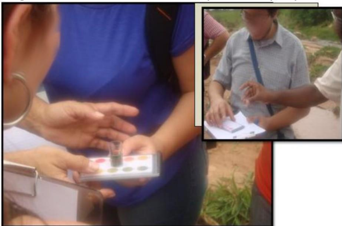
Figura 16: Professores realizando leitura das análises químicas, verificação de pH e cloro.
