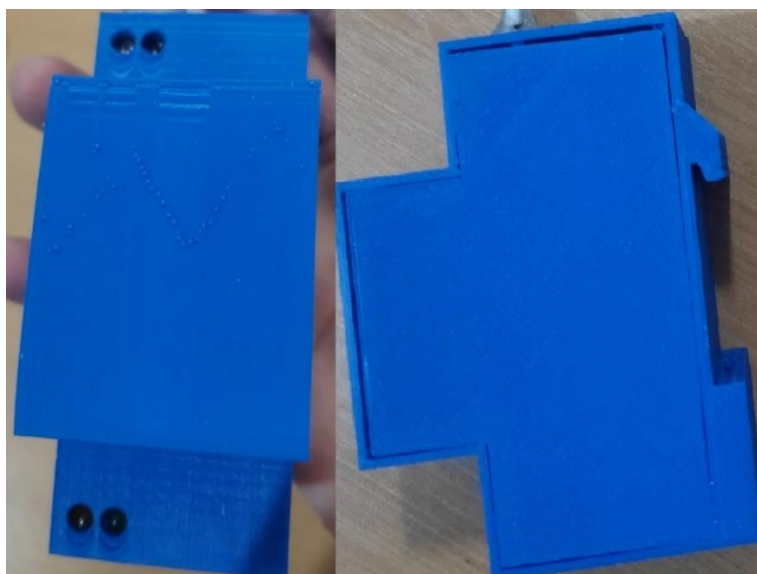
Figura 22 - Invólucro feito por impressão 3D.
