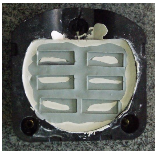
Figura 14 – Aspecto final da matriz de silicone para laboratório.
