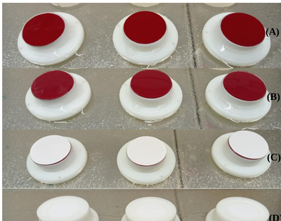
Figura 5: Etapas de montagem do dispositivo DGT: (A) gel ligante, (B) gel difusivo, (C) filtro, (D) luva de polipropileno.
