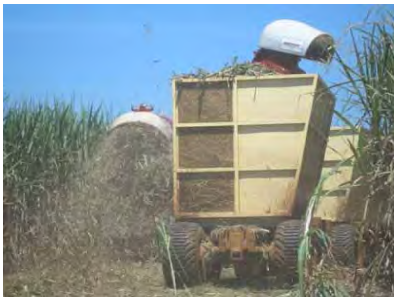
Figura 34 – Colheita mecanizada de cana-de-açúcar crua mostrando o grande volume de palha que é separado pelo extrator primário.
