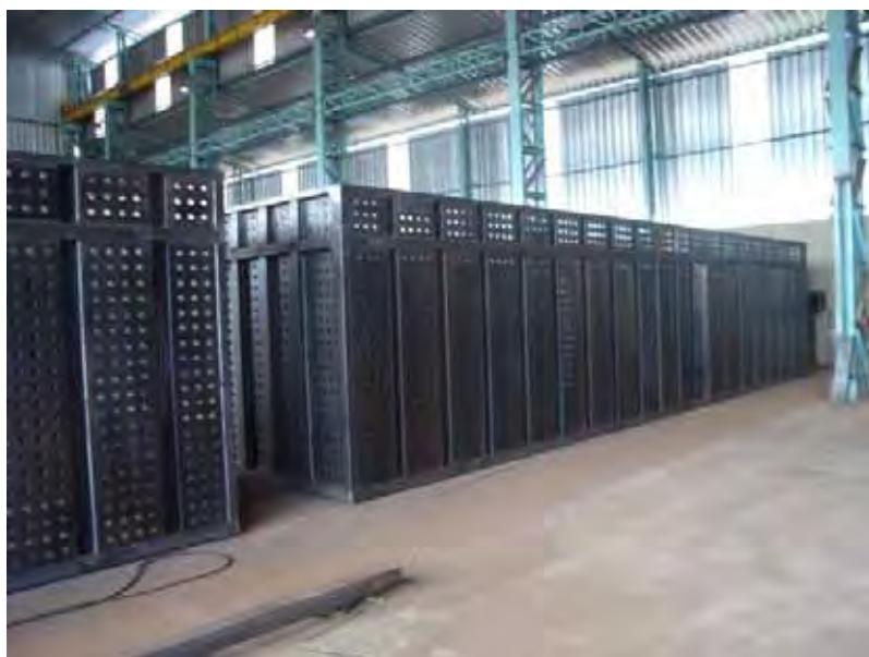
Figura 38 – Caixa de armazenagem de cana-de-açúcar picada que irá ser colocada sobre o chassi do semi-reboque.
