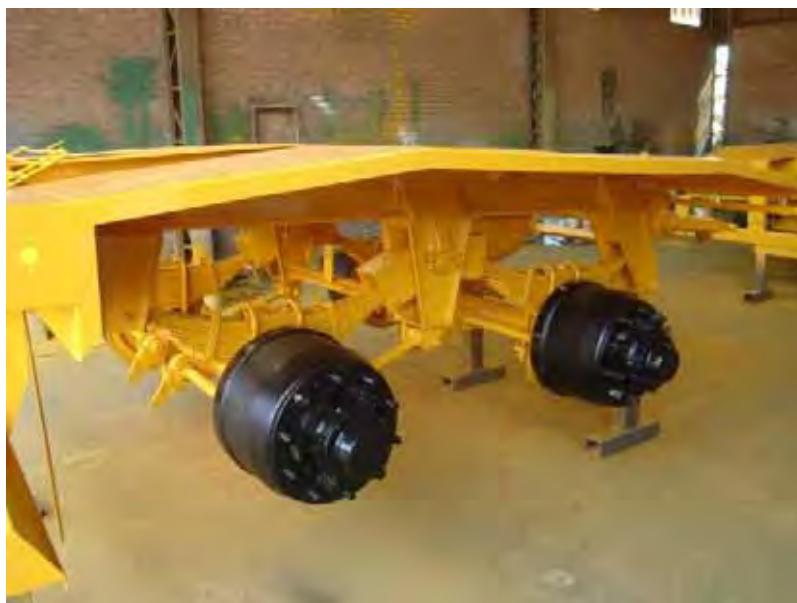
Figura 39 – Dolly canavieiro em fase final de fabricação.
