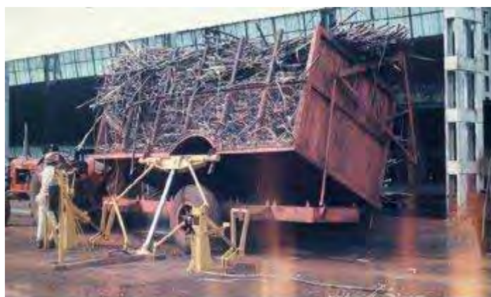
Figura 13 – Basculamento com auxílio de pistão hidráulico para cana-de-açúcar inteira. Fonte: Ripoli e Ripoli (2005).
