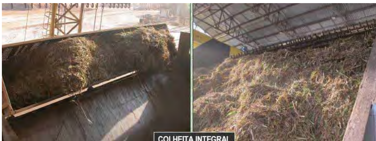
Figura 16 – Descarregamento da cana crua na mesa alimentadora. Fonte: Hassuani (2007).
