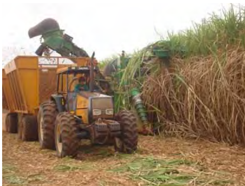
Figura 29 – Colheita mecanizada de cana-de-açúcar com limpeza da palha, acompanhada pelo conjunto transbordo.
