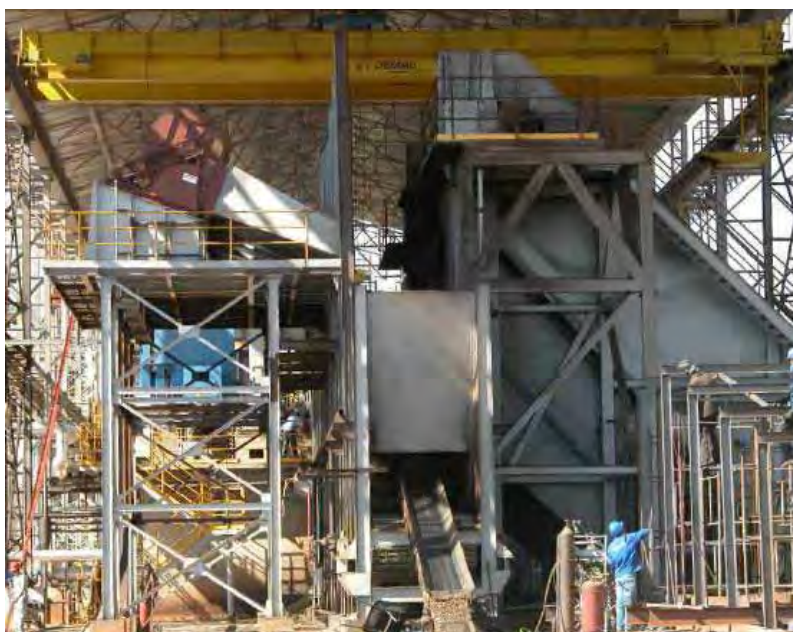
Figura 25 – Sistema de lavagem a seco em operação. Fonte: Hassuani (2007).
