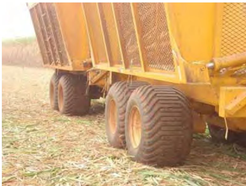
Figura 33 – Pneu de alta flutuação do transbordo para minimizar a compactação do solo no sistema de colheita mecanizada.
