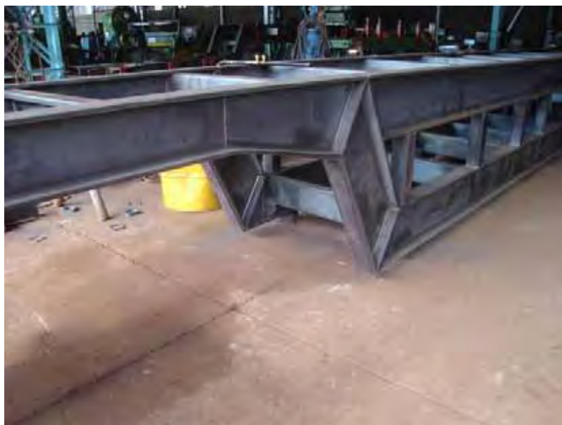
Figura 37 – Fabricação do chassi de um semi-reboque de cana-de-açúcar picada.
