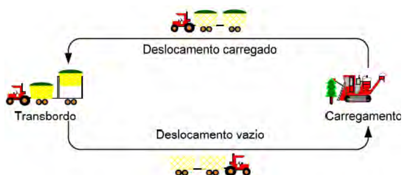
Figura 2 – Representação do ciclo realizado pelo conjunto transbordo na operação de colheita mecanizada de cana-de-açúcar. Fonte: Silva (2006).
