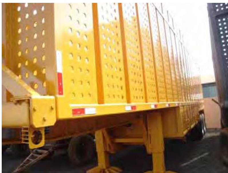
Figura 40 – Semi-reboque de cana-de-açúcar picada em fase final de fabricação.
