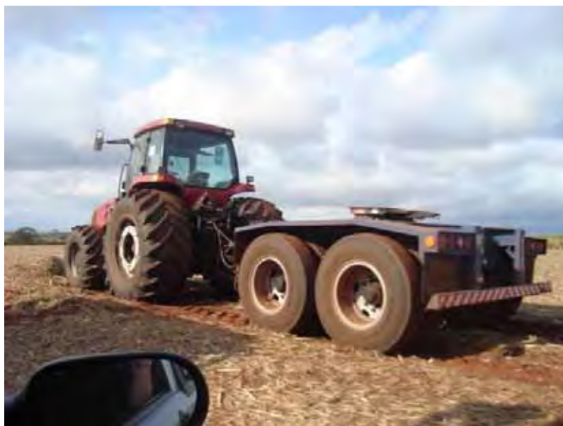
Figura 31 – Detalhe de um dolly canavieiro utilizado para acoplar dois semi-reboques.
