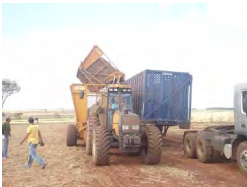
Figura 30 – Transferência da carga do transbordo para o semi-reboque, responsável por fazer o transporte rodoviário.
