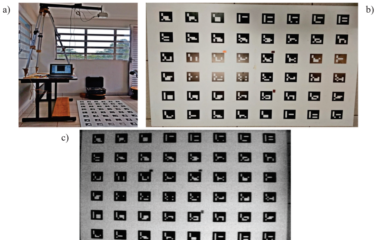
Figura 25 – a) Ensaio realizado. b) Placa com alvo codificados. c) Exemplo de imagem adquirida.
