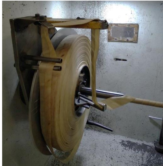
Figura 2 – Processo de Bandagem
