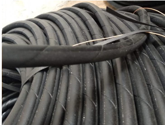
Figura 11 – Fita Match-mate invertida / Sem fita
