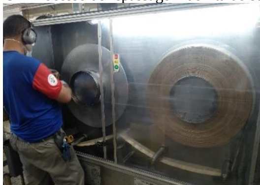
Figura 43 – Processo de repassagem de fita de bandagem
