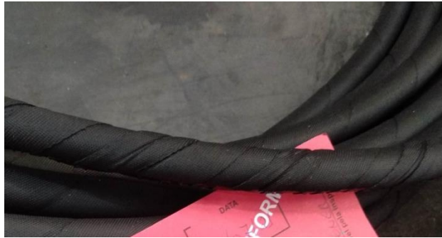
Figura 16 – Fita de Bandagem torcida
