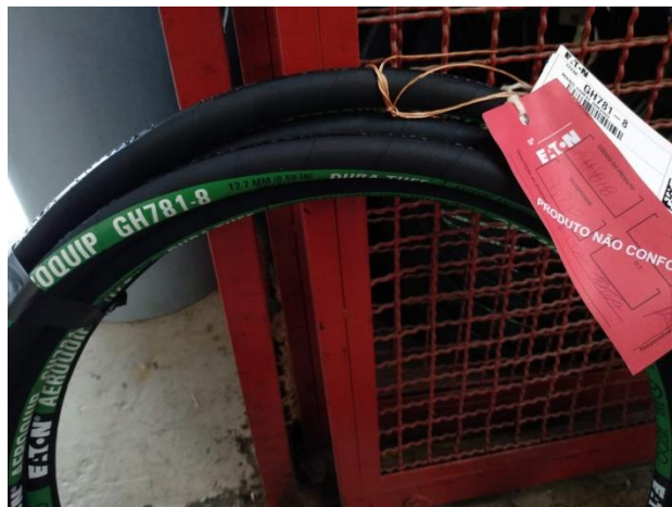
Figura 10 – Fita Match-mate desalinhada
