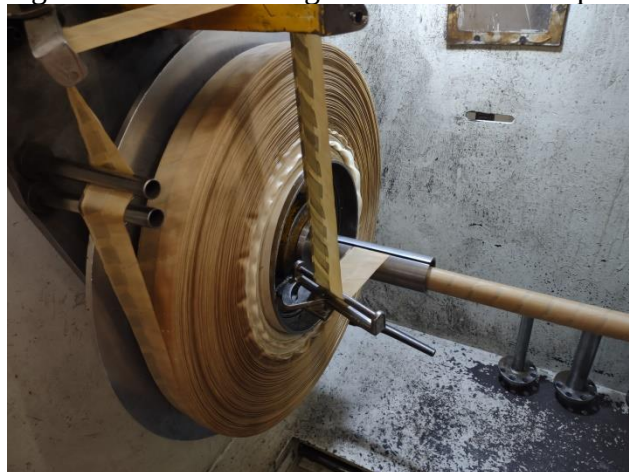
Figura 46 – Novo tubo guia instalado na máquina
