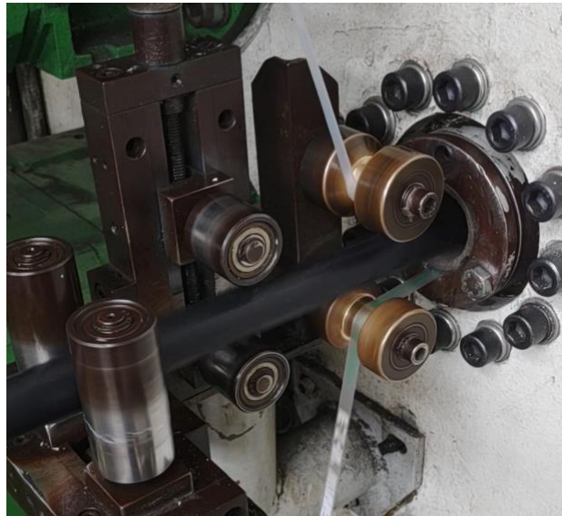
Figura 45 – Entrada da mangueira na máquina de bandagem junto com as fitas Lay-line e Match-mate
