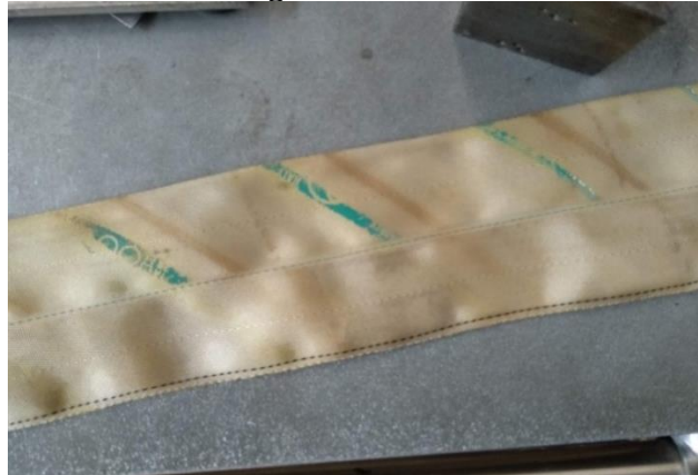
Figura 42 – Fita de bandagem manchada com a fita Match-mate
