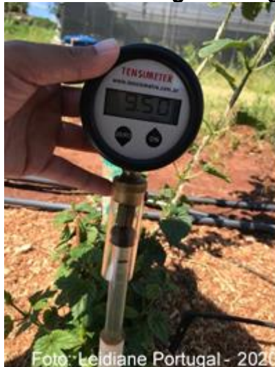
Figura 13 - Leitura de tensão em tensiômetro de cápsula porosa com a utilização de tensímetro digital de agulha
