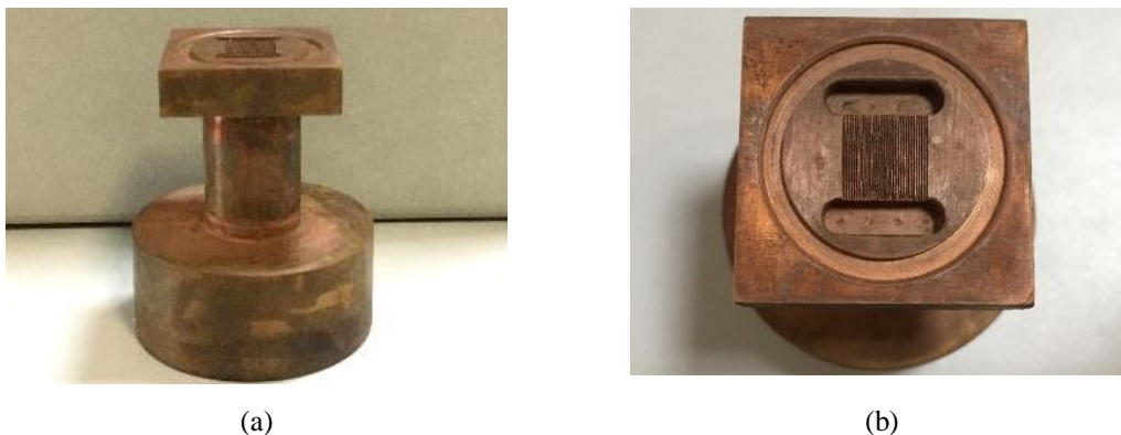
Figura 18 - Base dos microcanais soldada no suporte/tarugo de cobre. (a) vista lateral; (b) vista superior.
