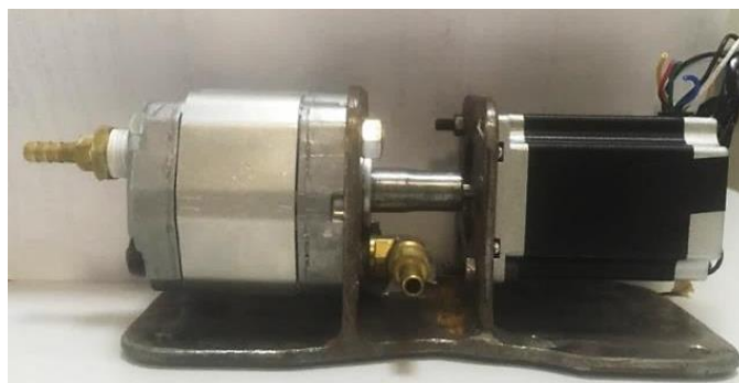
Figura 24 - Bomba de engrenagem junto ao motor de passo.
