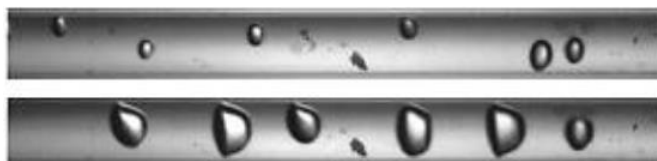
Figura 8 - Escoamento borbulhado com bolhas dispersas (acima) e transição bolhas/ plug (abaixo).
