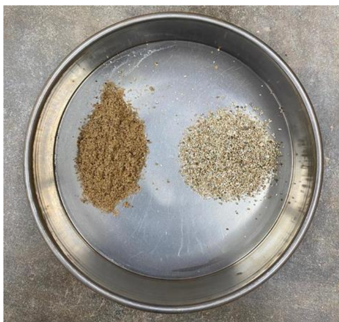
Figura 11 - Areia natural (à esquerda) e vermiculita (à direita)
