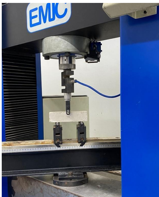
Figura 6 - Ensaio de resistência à tração na flexão
