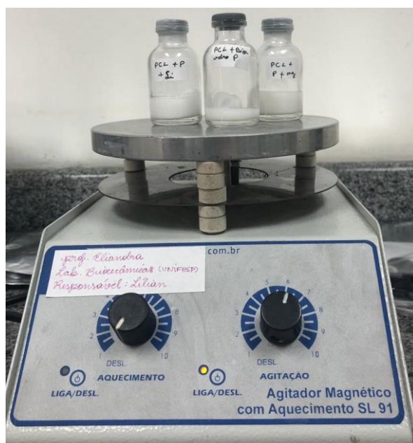
Figura 1 – Três soluções foram colocadas no agitador magnético por 24 horas: biovidro produzido pela rota sol-gel precipitado, biovidro dopado com Mg e biovidro dopado com Li.
