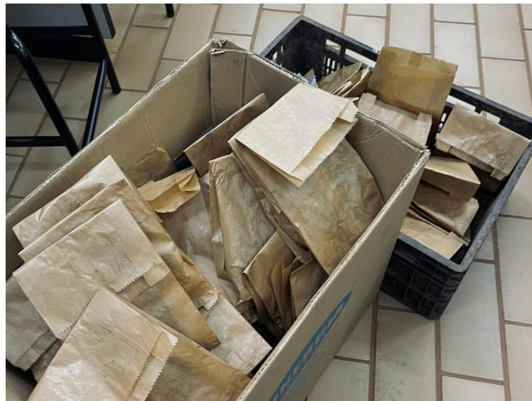
Figura 7 – Amostras sendo preparadas para a secagem em estufa para determinação da biomassa seca.
