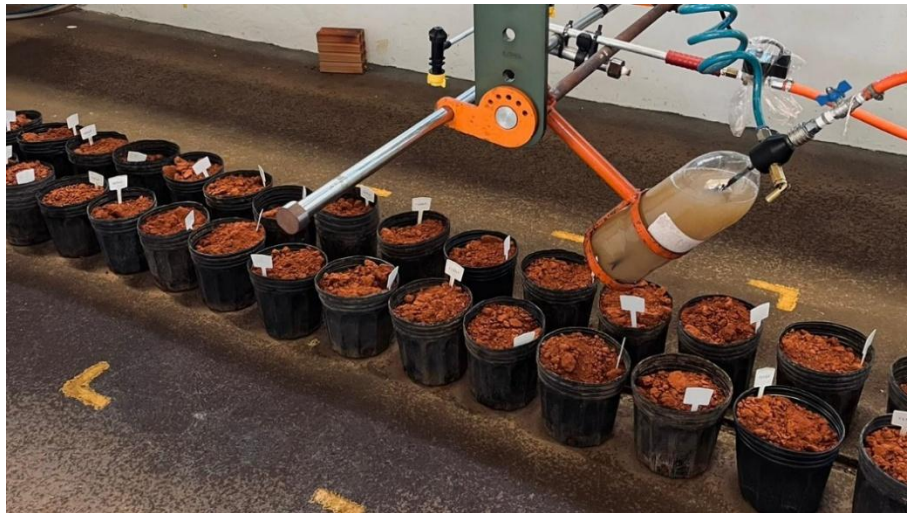
Figura 3 – Aplicação dos pesticidas a partir do pulverizador laboratorial automático.
