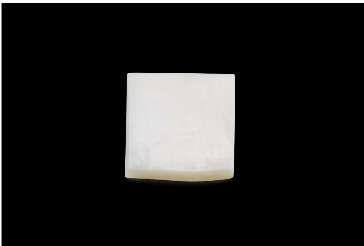
Figura 2. Espécime de PMMA reticulado para CAD/CAM com dimensões de 5 \times 5 \times 1,5 mm.
