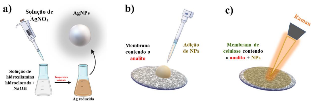
Figura 3 – Preparo das amostras para SERS: (a) primeiramente, foi preparado colóide de nanopartículas de Ag pelo método de Leopold e Lendl, e então (b) foram depositadas sobre o filtro a ser analisado. Por fim, (c) espectros SERS foram obtidos.
