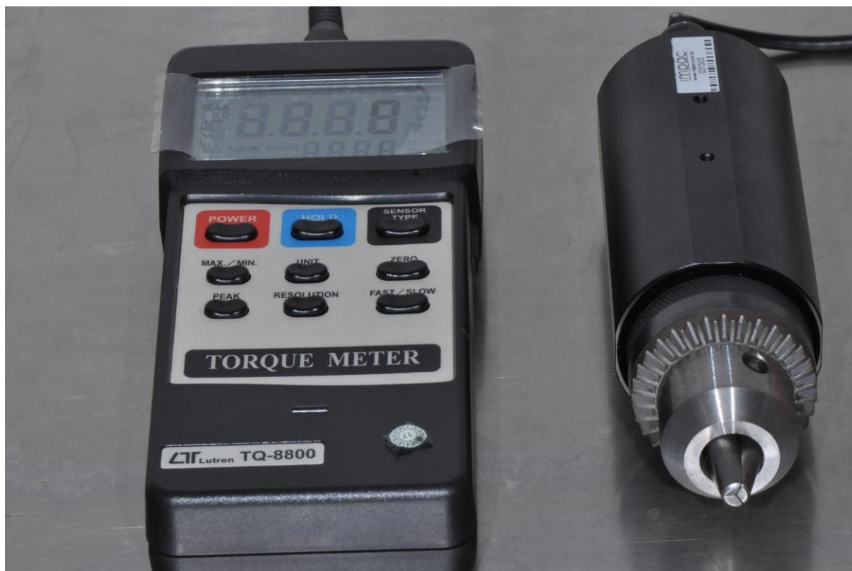
Figura A12 - Torquímetro Digital Portátil utilizado na análise biomecânica
