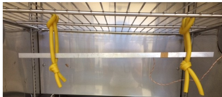
Figura 15: Viga suspensa por elásticos simulando a condição livre-livre.
