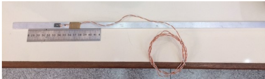
Figura 13: Viga com PZT acoplado em sua superfície.
