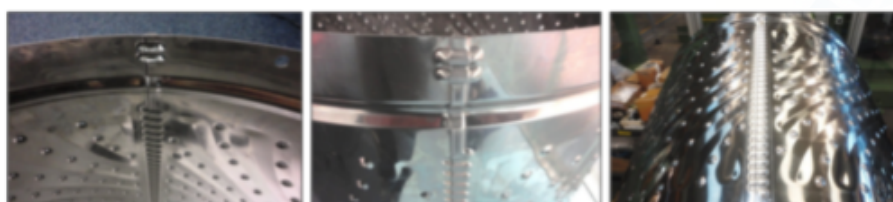
Figura 26 – Exemplo de cestos VA com travamento mecânico finalizado
