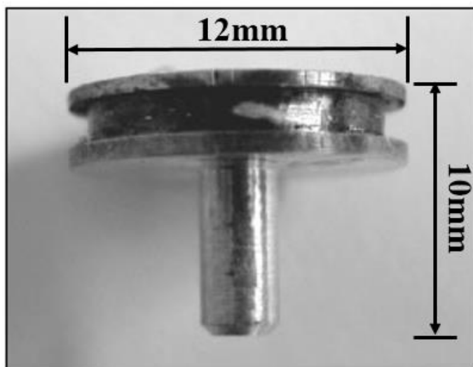
Figura 11: Porta-amostra ( stub ) utilizado para medidas de microscopia eletrônica de varredura.
