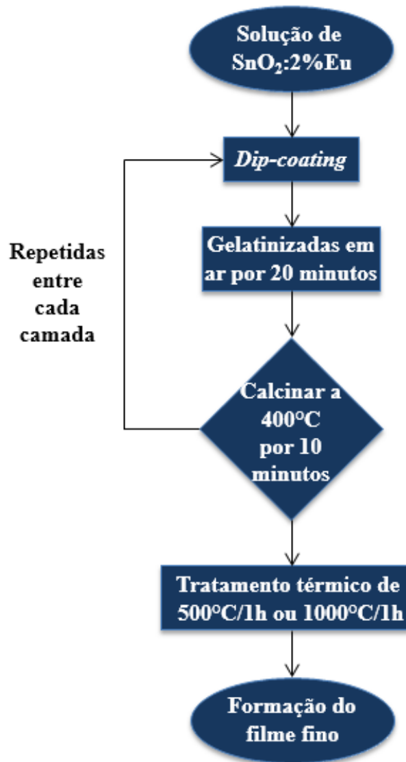
Figura 7: Fluxograma do esquema utilizado para a deposição dos filmes finos por dip-coating .
