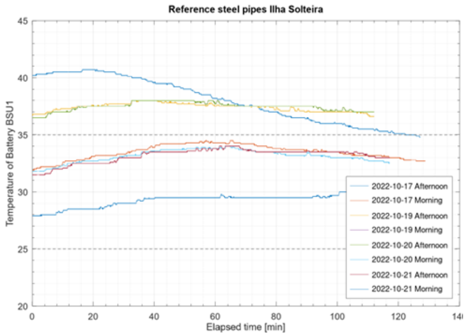
Figura 50 – Resultados da temperatura da bateria 2 do conjunto do teto nos testes com a configuração de referência (steel pipes) em Ilha Solteira
