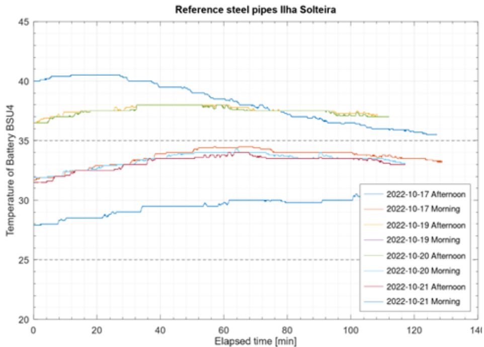
Figura 53 – Resultados da temperatura da bateria 1 do conjunto da traseira nos testes com a configuração de referência (steel pipes) em Ilha Solteira
