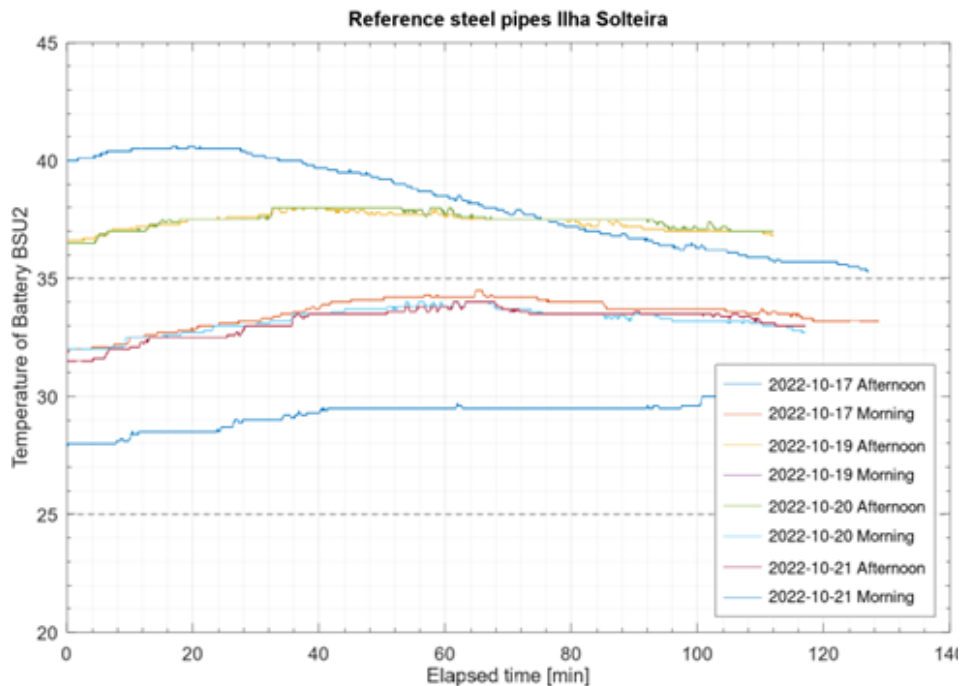
Figura 51 – Resultados da temperatura da bateria 3 do conjunto do teto nos testes com a configuração de referência (steel pipes) em Ilha Solteira
