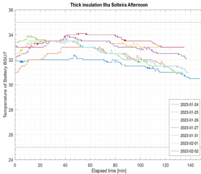
Figura 72 – Resultados da temperatura da bateria 4 do conjunto da traseira nos testes com a variante thick insulation em Ilha Solteira
