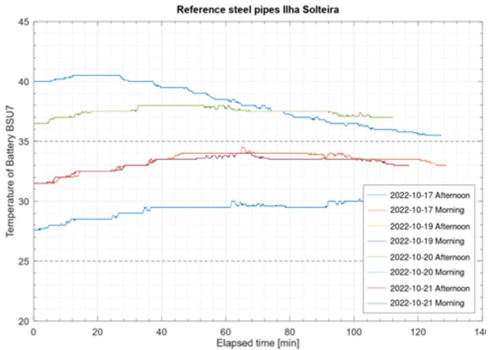
Figura 56 – Resultados da temperatura da bateria 4 do conjunto da traseira nos testes com a configuração de referência (steel pipes) em Ilha Solteira
