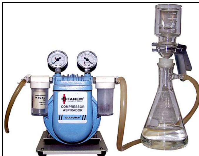
Figura 13. Sistema de Filtração
