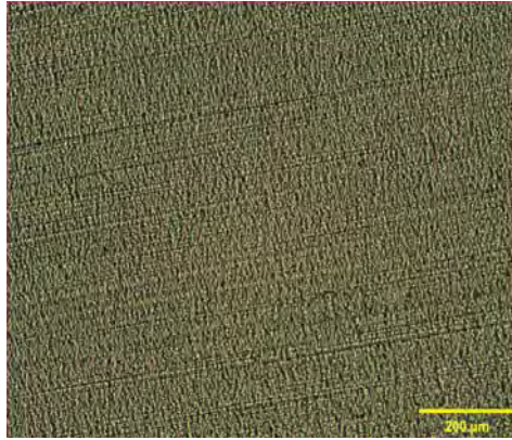
Figura 7A. Microscopia de Luz Polarizada do filme de PEBD após o termotratamento
