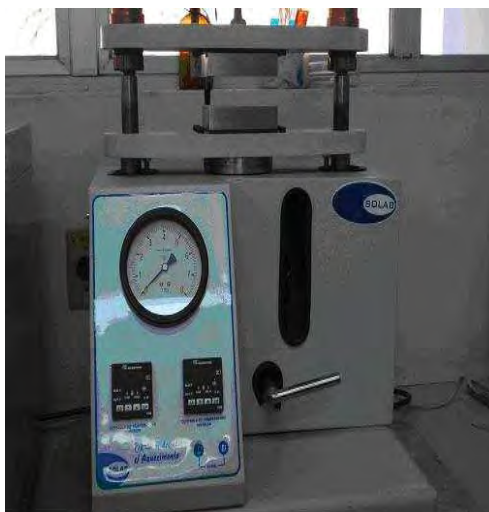
Figura 3. Prensa hidráulica utilizada no preparo das blendas e dos filmes de homopolímero
