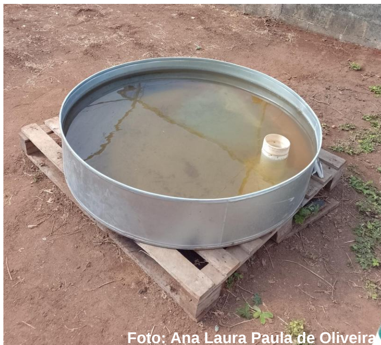
Figura 4 - Tanque Classe A utilizado para mensurar a quantidade de água a ser irrigada no experimento
