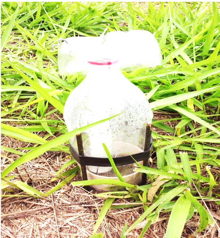
Foto 4 - Câmara para avaliação da volatilização de amônia.
