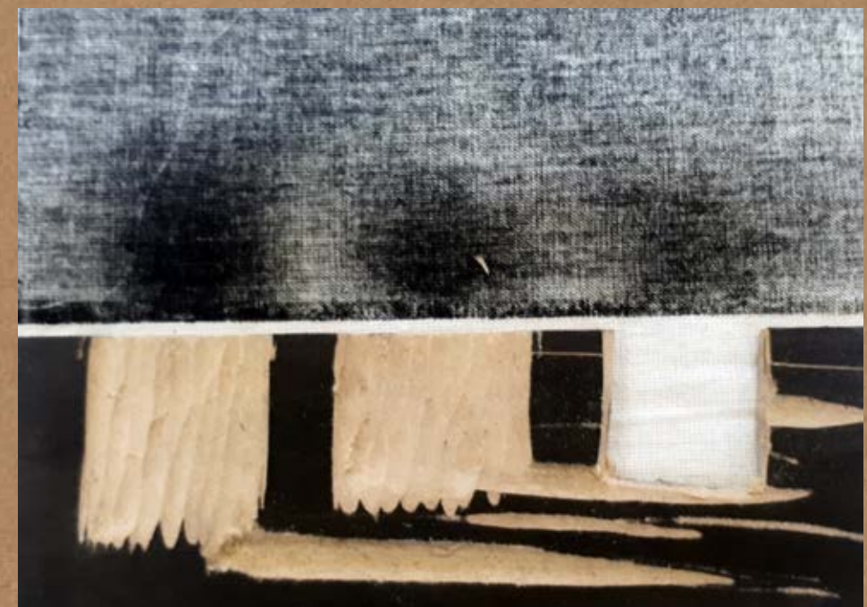
Figura 99 - Registro da 2ª impressão e da matriz utilizada como Contrapeso no experimento de impressão considerando diversas profundidades de gravação.
