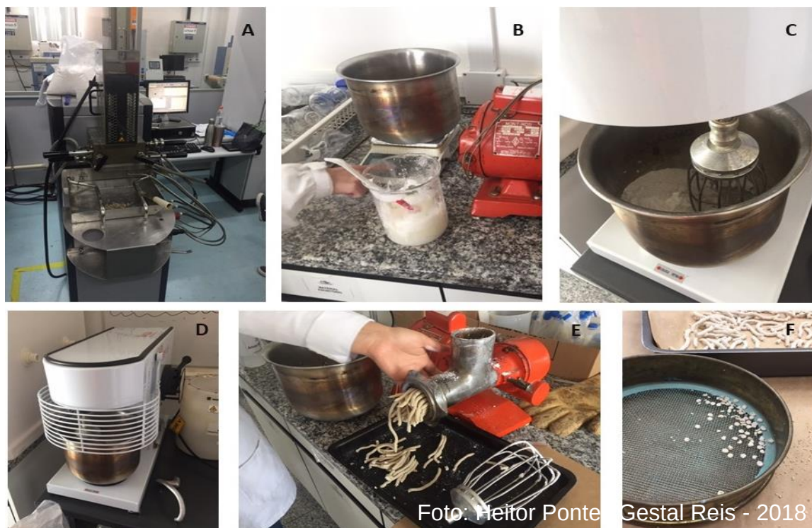
Figura 1 - Procedimentos para produção dos nanocompósitos fosfatados. (A) Reômetro de torque; (B) mistura de amido e argila; (C) hidroxiapatita nanométrica sendo adicionada ao amido; (D) mistura dos materiais; (E) extrusão a frio do fertilizante; (F) granulometria final do fertilizante
