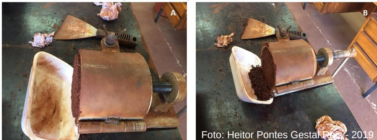
Figura 3 - Fatiamento do solo em camadas de 0,5 cm para análises químicas de solo. (A) Amostra de 0,5 sendo retirada do PCG. (B) Amostra de solo coletada para análise química do solo
