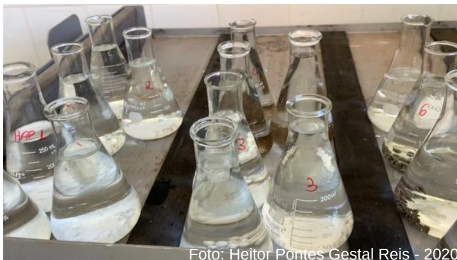
Figura 2 - Ensaio de liberação dos fertilizantes fosfatados em solução de ácido cítrico a 2% com pH = 2,3
