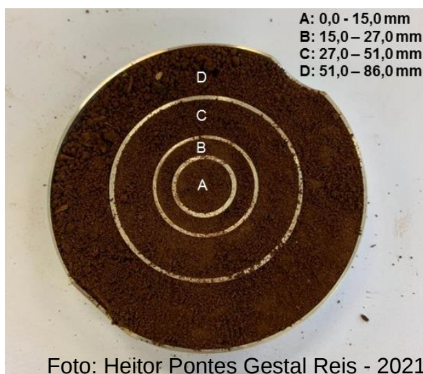
Figura 4 - Amostragem da Placa de Petri em anéis concêntricos após 43 dias de incubação com fertilizantes fosfatados
