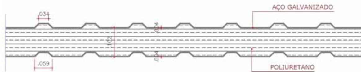
Imagem da relha de aço galvanizado com recheio de poliuretano expandido. Desenho sem escala.
