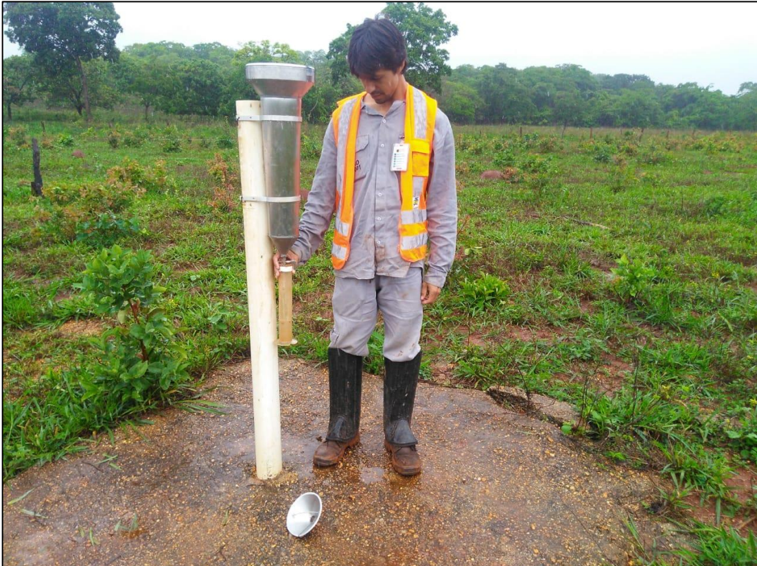
Figura 5.4 Monitoramento de precipitação a partir de pluviômetros Ville de Paris.
