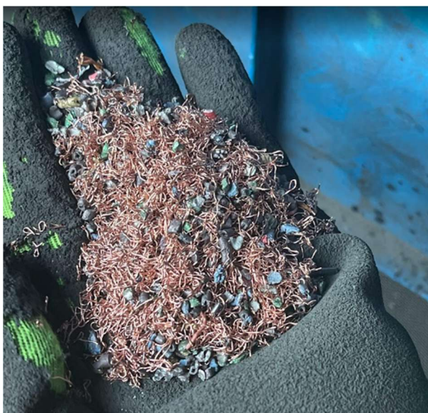
Imagem 1: Foto dos fios e cabos moídos antes da separação
