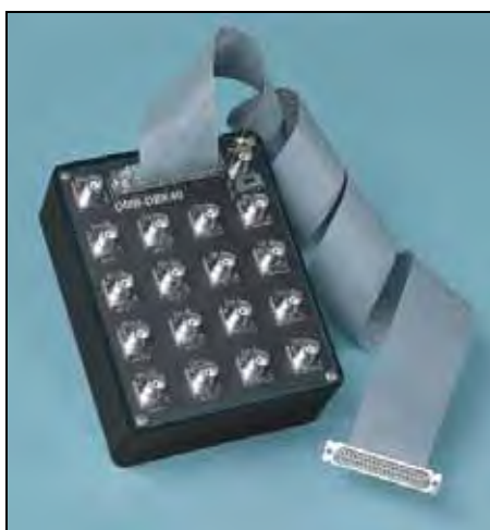
FIGURA 3-4: FOTO DO EQUIPAMENTO PARA AQUISIÇÃO DE SINAIS DE CORRENTE, MODELO DBK40
