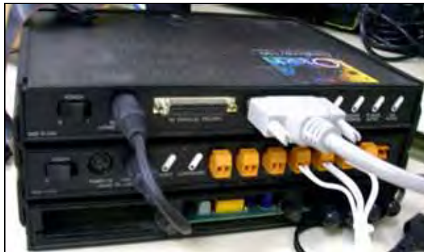
FIGURA 3-2: FOTO DO EQUIPAMENTO PARA AQUISIÇÃO DE DADOS, MODELO DAQBOOK/100
