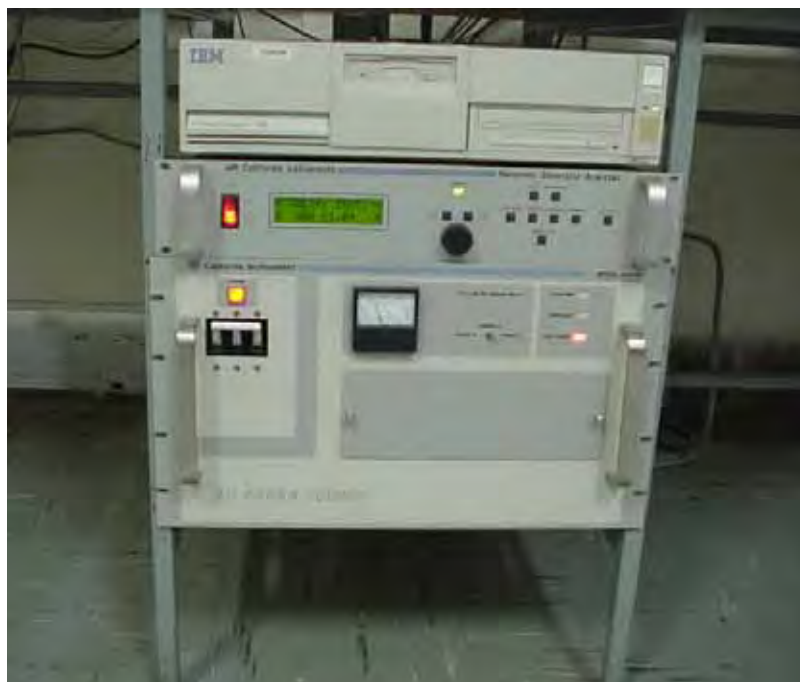
FIGURA 3-1: FOTO DA FONTE DE TENSÃO TRIFÁSICA E DO GERADOR ANALISADOR DE HARMÔNICAS
