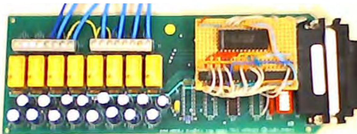
FIGURA 3-7: FOTO DE UMA PLACA DA MATRIZ DE CHAVEAMENTO
