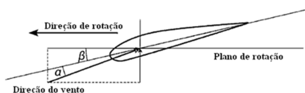
Figura A.13: Corte transversal de pá de uma turbina eólica.
