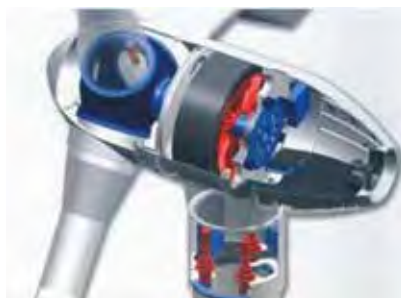
Figura A.16: Gerador síncrono diretamente conectado ao eixo da turbina.
