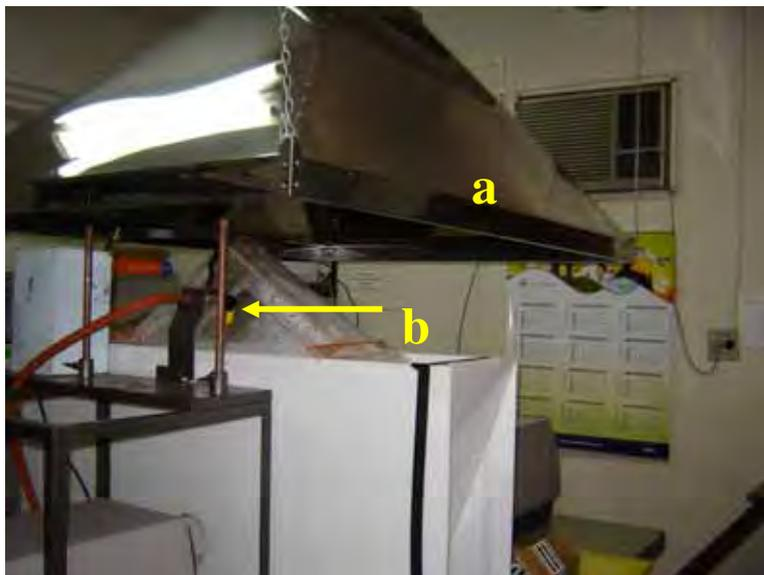
Figura 18 - Detalhe do exaustor tipo coifa (a) e jato de pulverização (b).
