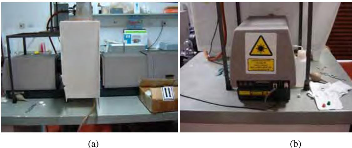
Figura 17 - Analisador de diâmetro de partículas por difração de raios Laser Mastersizer S®, versão 2.15. vista lateral (a) e canhão laser (b).
