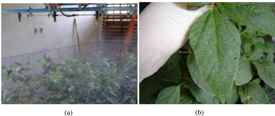
Figura 7 - Disposição das pontas XR 11001 (gotas finas), utilizadas para a pulverização (a) e características de depósito da folha pulverizada (b).
