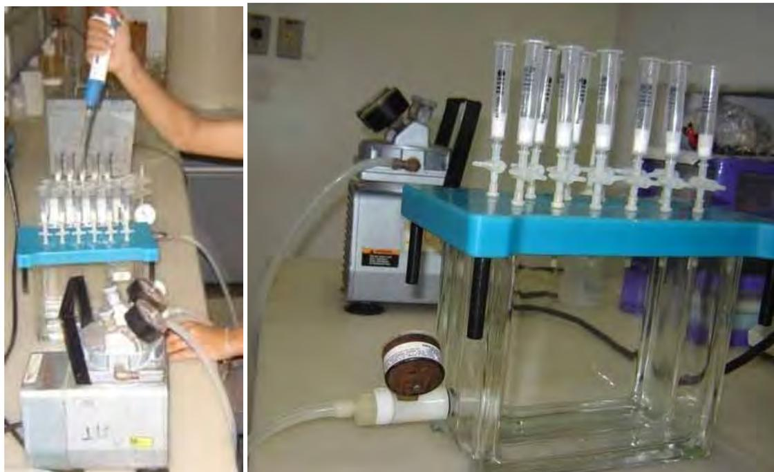
Figura 14 - Extração do ingrediente ativo. Resuspensão em C18 (a), filtragem (b).
