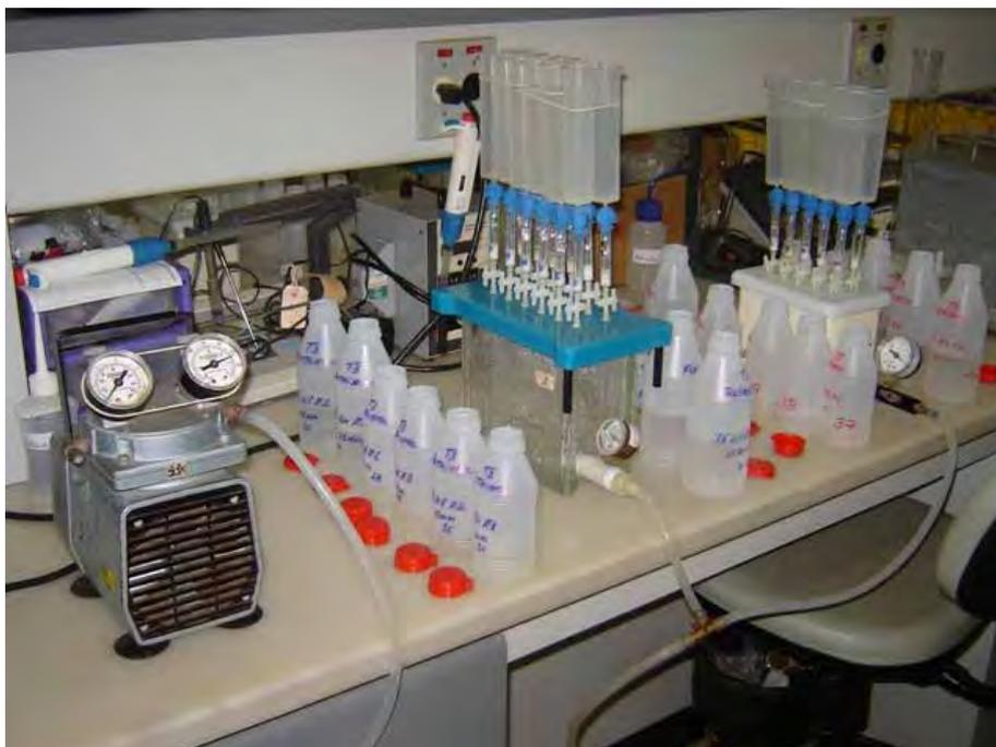
Figura 13 - Filtração das amostras em Carbone 18.
