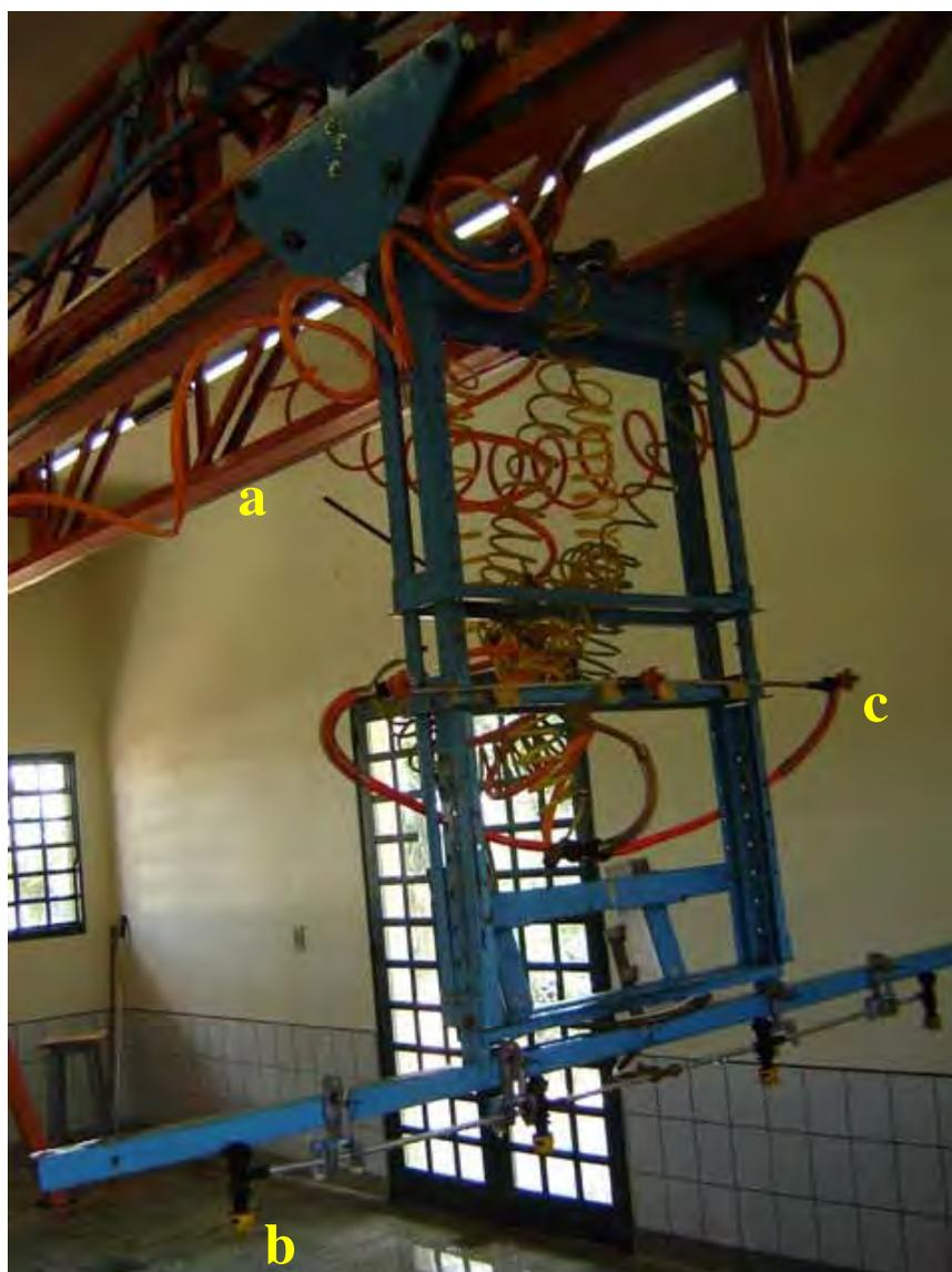
Figura 5 - Simulador utilizado para aplicação das caldas e das lâminas de chuva. Detalhes do trilho suspenso (a) que movimenta a estrutura de suporte da barra pulverizadora com os bicos de pulverização (b) e os bicos de simulação de chuva (c).
