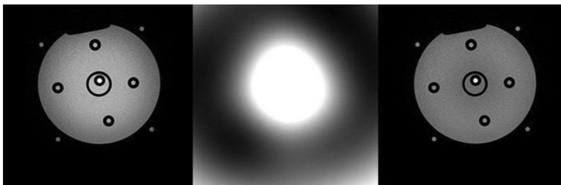
Figura 17: a) Imagem original de RM, b) filtro de correção, e c) imagem corrigida (Fonte: próprio autor).
