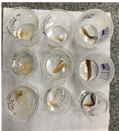
Figura 10. Amostra do bioplástico com ácido málico após solubilizada em água e seca
