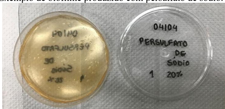
Figura 11. Exemplo de biofilme produzido com persulfato de sódio.
