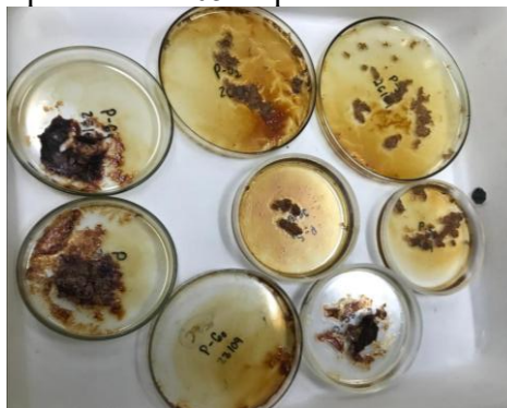
Figura 7. Pectina seca após estufa 105°C para amostras de pH 5 e 6.
