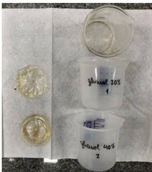
Figura 9. Amostra do bioplástico com glicerol após solubilizada em água e seca
