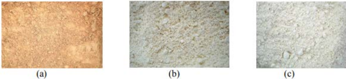
Figura 9 – Diferentes tipos de metacaulim produzidos por diferentes empresas: a) Metacaulim do Brasil, b) Advanced Cement Technologies, c) Engelhard.
