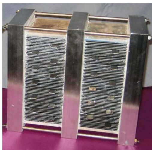
Figura 7 – Esquema do funcionamento de um eletrolisador de óxido sólido (a) e foto de um protótipo de eletrolisador SOE (b).
