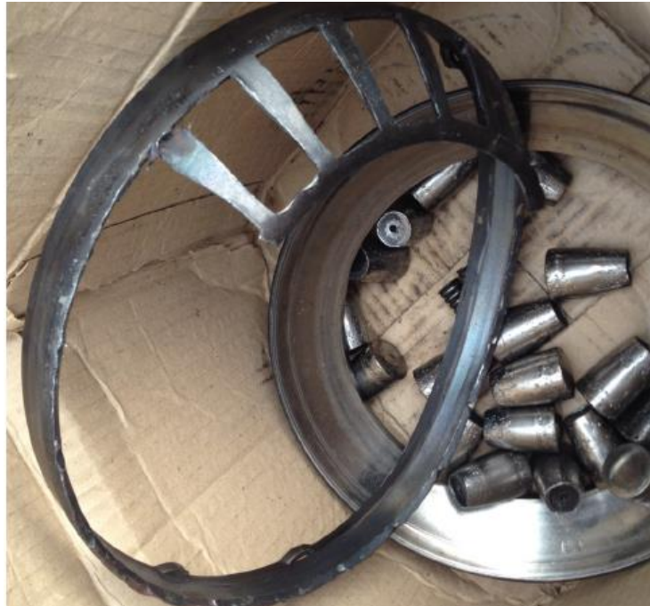
Figura 5 – Gaiola do rolamento SKF 29326E.
