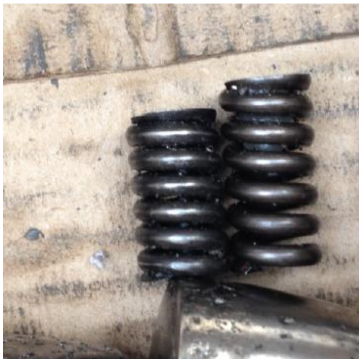
Figura 7 – Molas utilizadas na montagem do rolamento SKF 29326E.
