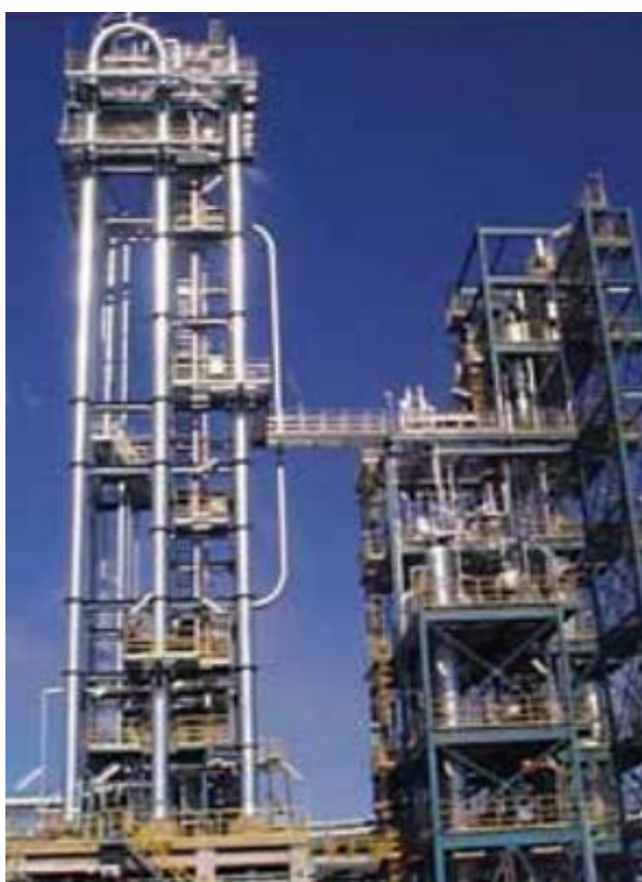
Figura 1 – Reator tipo loop slurry utilizado para polimerização de olefinas.
