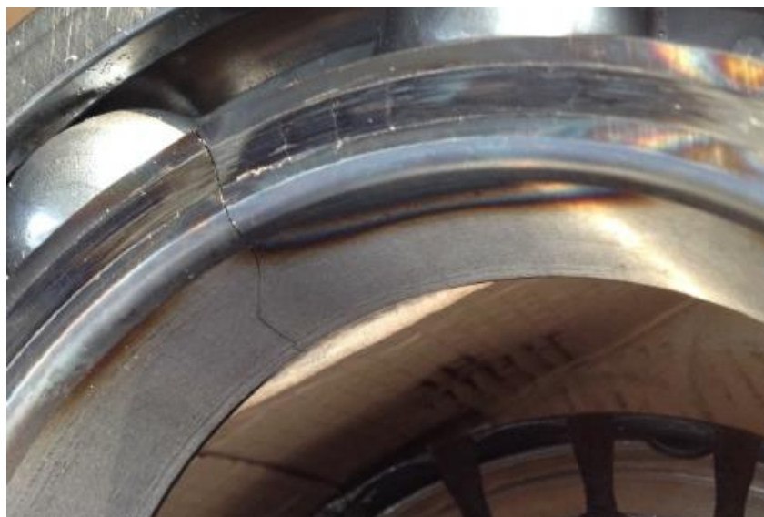
Figura 8 – Anel interno do rolamento SKF 6224.
