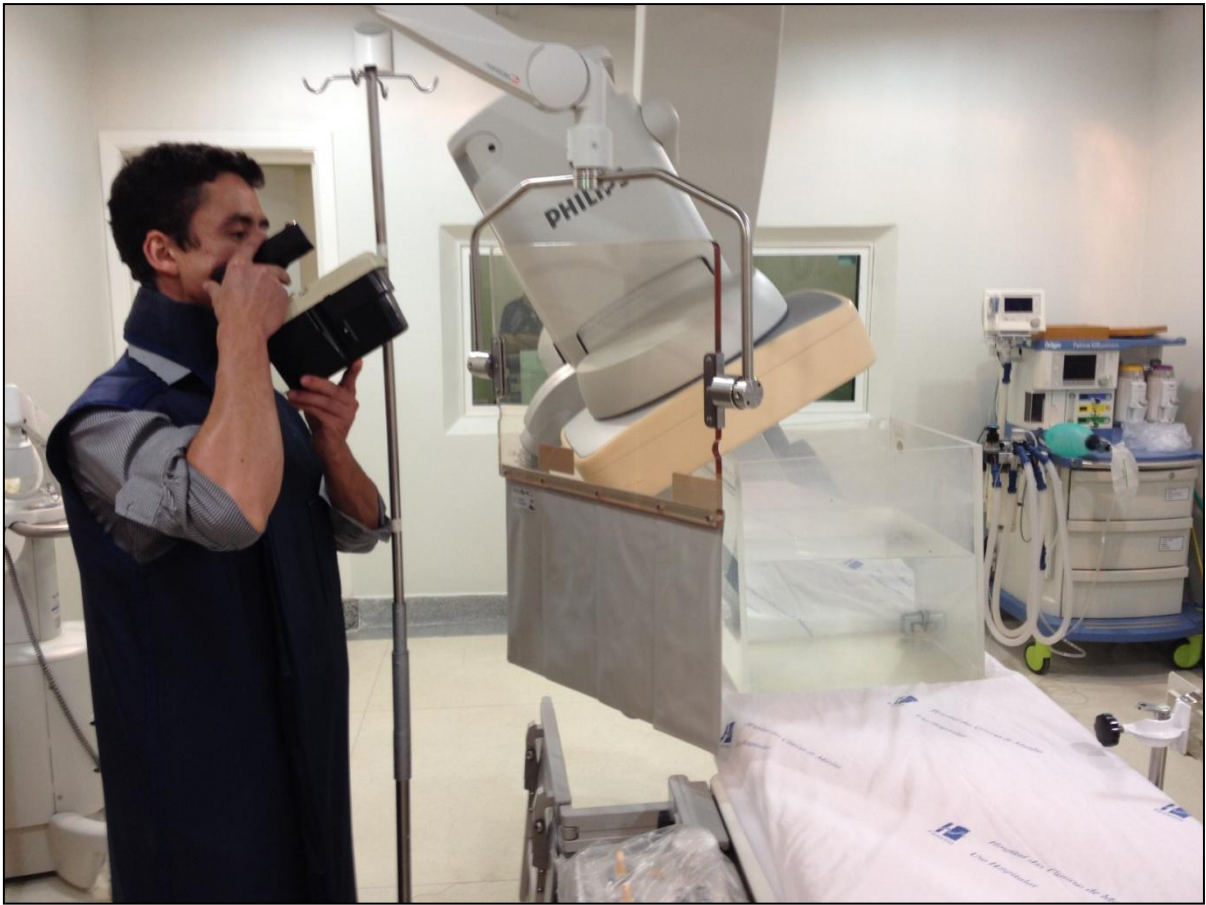
Figura 8. Processo de mensuração radiológica com câmara de ionização
