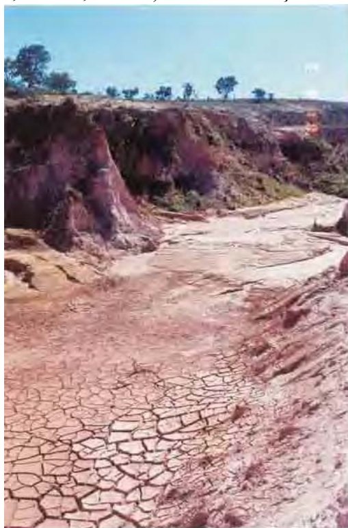
Figura 17 – Implantação de processos erosivos em solo arenoso oriundo da alteração do Membro Serra da Galga (Formação Marília). Ponto 66 (APÊNDICE 1) – Estrada não pavimentada que liga o distrito de Mangabeira (MG) à BR-050 na altura do posto Tijuco, entre Uberaba (MG) e Uberlândia (MG).
