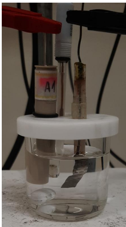
Figura 13. Célula eletrolítica de três eletrodos preparada para análise.
